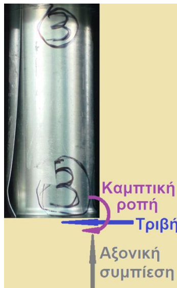
Εικόνα 3.1 Έναρξη κατάρρευσης στο (κάτω) άκρο του κελύφους
