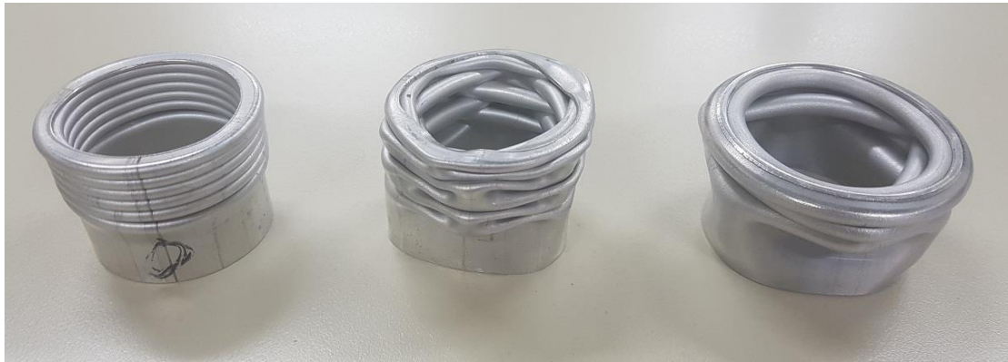
Εικόνα 1.6 Αξονοσυμμετρικός, Μη συμμετρικός και Μικτός τρόπος κατάρρευσης
