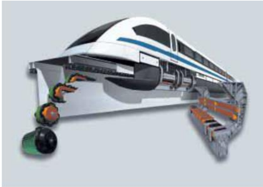
Εικόνα 2.3.α: Από τον περιστροφικό, στον ευθύγραμμο κινητήρα επί του οχήματος [18]
