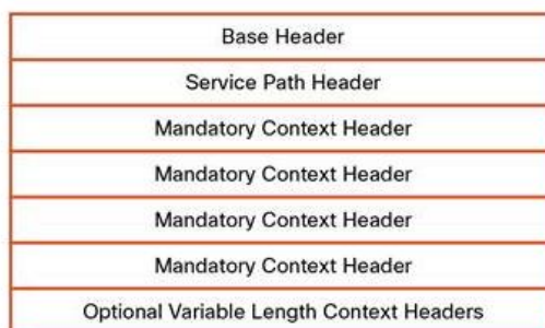
Εικόνα 7.25 Κεφαλίδα VXLAN-GPE με NSH
