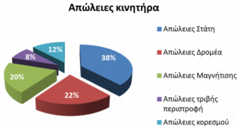
Εικόνα 1.10: Ποσοστά απωλειών κατά τη λειτουργία ενός κινητήρα(Μπουντάκης, 2012)
