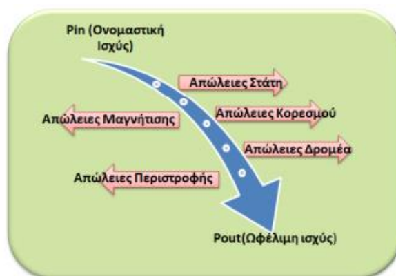
Εικόνα 1.9: Απώλειες κατά τη λειτουργία ενός κινητήρα(Μπουντάκης, 2012)
