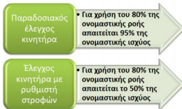
Εικόνα 2.31: Διαφορές μεταξύ των συμβατικών τρόπων ελέγχου και ρυθμιστών στροφών(Μπουντάκης, 2012)
