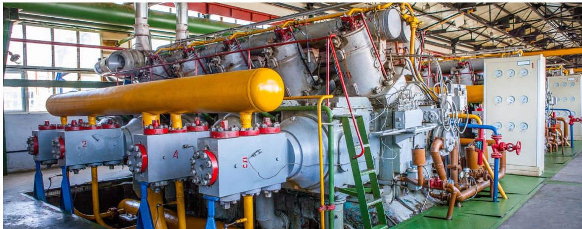
Εικ. 6: Συμπίεστής κλειστού τύπου [34]
