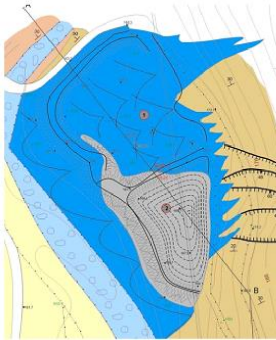
Εικόνα 3.3: Τοπογραφική και γεωλογική αποτύπωση της περιοχής των λεκανών 1 και 2 (Από τον γεωλογικό χάρτη της περιοχής εργοστασίου εμπλουτισμού Κίρκης). (Λουπασάκης & Κωνσταντοπούλου, 2007)
