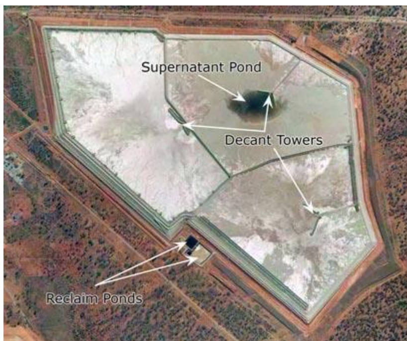
Εικόνα 2.20: Χώρος απόθεσης με περιμετρικό ανάχωμα «δακτυλοειδούς τύπου» με τρία κελιά απόθεσης. ( http://www.tailings.info )
