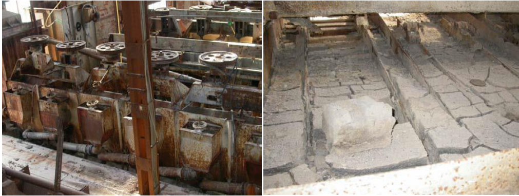
Εικόνες:2.10,2.11.: Κυψέλες εμπλουτισμού στις οποίες διακρίνεται υλικό επεξεργασίας. (Λιακοπουλος, 2009)
