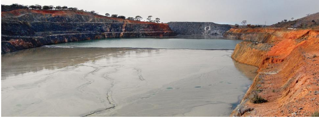
Εικόνα 2.21: Απόθεση αποβλήτων επεξεργασίας μεταλλεύματος Χρυσού εντός χώρου ανοικτής εκσκαφής. ( www.srk.com.au )
