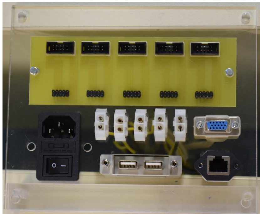
Σχήμα 4-17. Plexiglas με υποδοχές & ηλεκτρονική πλακέτα.
