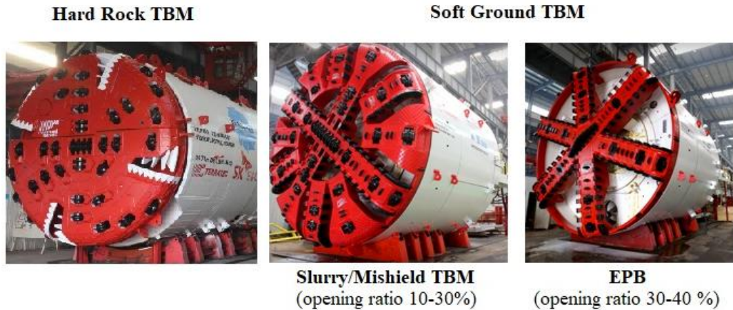
Εικόνα 2.4: Κοπτικές κεφαλές διαφόρων τύπων TBM (www.terratec.co).
