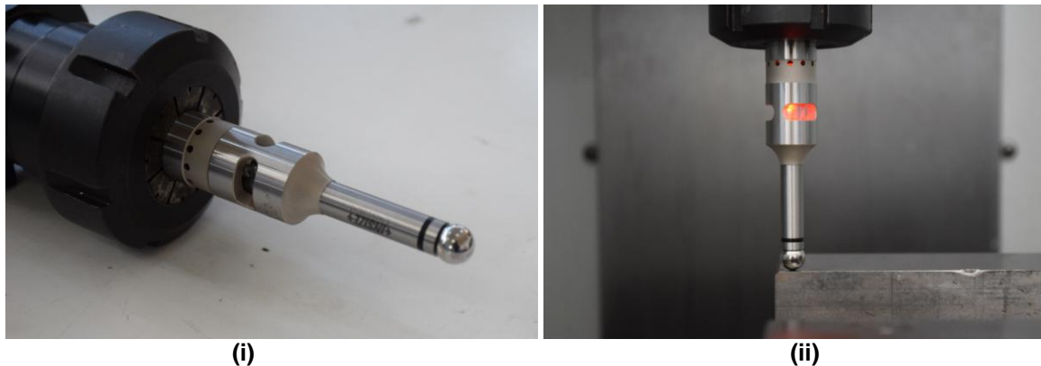
Σχήμα 4-25. (i) Ηλεκτρονικό εργαλείο εύρεσης ακμής, (ii) Μέτρηση θέσης επιφάνειας.
