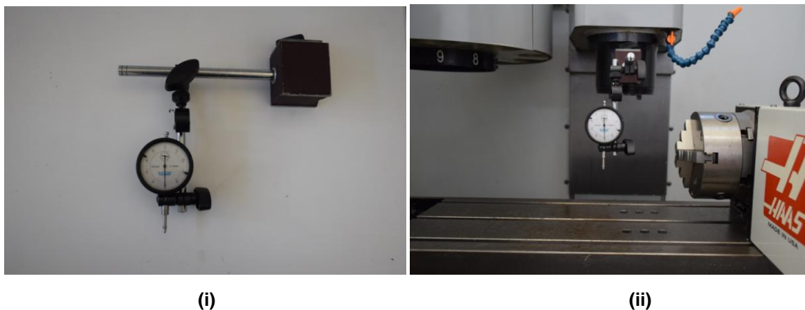
Σχήμα 4-24. (i) Αναλογικός μετρητής μετατόπισης, (ii) Σύνδεση μετρητή στην άτρακτο της εργαλειομηχανής.
