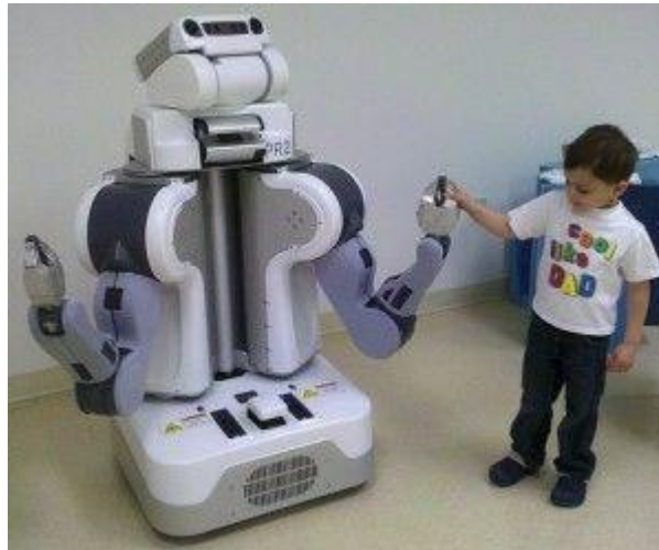
Σχήμα 2-3. Το Personal Robot PR-2 της Willow Garage [13].
