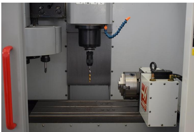
Σχήμα 4-20. Αυτόματο Κέντρο Κατεργασιών – Εσωτερικός Χώρος Εργασίας.
