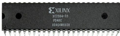
Figure 1.2: Το πρώτο εμπορικά διαθέσιμο FPGA του 1985 – το XC2064 †.
