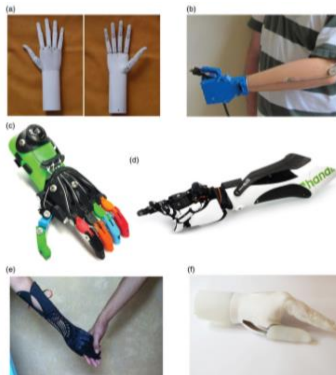
Εικόνα 75: Τρισδιάστατα εκτυπωμένα άνω άκρα: (A) Andrianesis'hand, (B) Gosselin'shand, (C) Cyborg Beast, (D) Handiii COYOTE, (E) IVIANA 2.0, (F) Scand [29].
