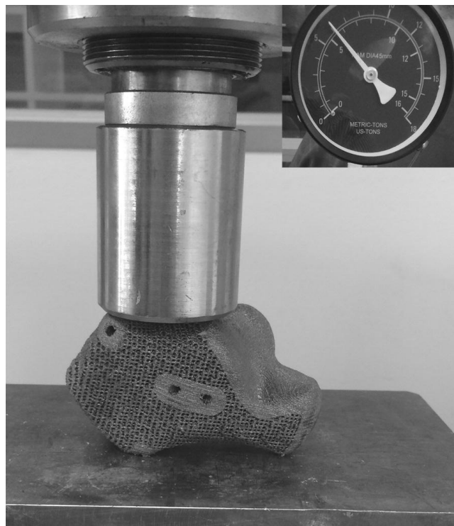
Εικόνα 53: Ένα πρωτότυπο της ασκήσεως πέλματος που δείχνει την ικανότητα να διατηρεί ένα φορτίο άνω των 6 τόνων [21].
