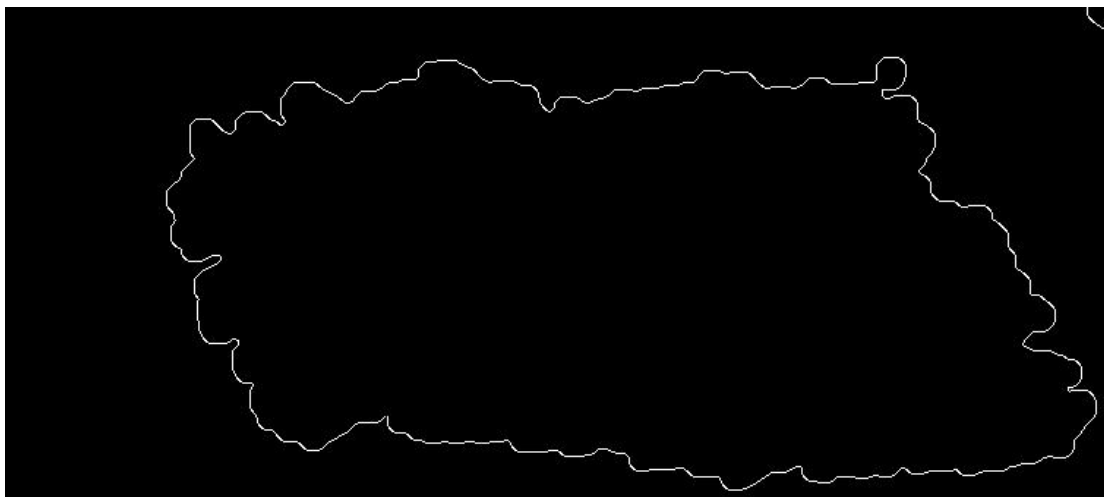
Εικόνα 33: Ανίχνευση ορίων υφάσματος προς εμποτισμό με χρήση του αλγορίθμου του Sobel
