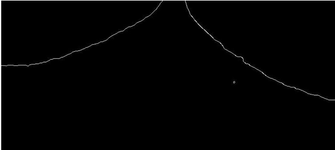
Εικόνα 22: Ανίχνευση Μετώπου Ροής Με Χρήση Αλγόριθμου Sobel
