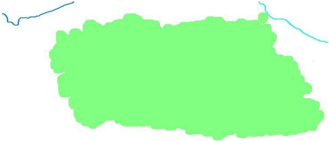
Εικόνα 41: Τα δύο εντοπισμένα μέτωπα ροής , και το υφάσμα που δεν έχει εμποτιστεί
