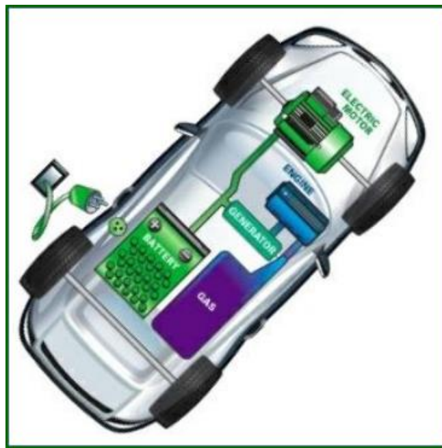
Εικόνα 3.6: Στοιχειώδη μέρη ενός E.R.E.V[29].
