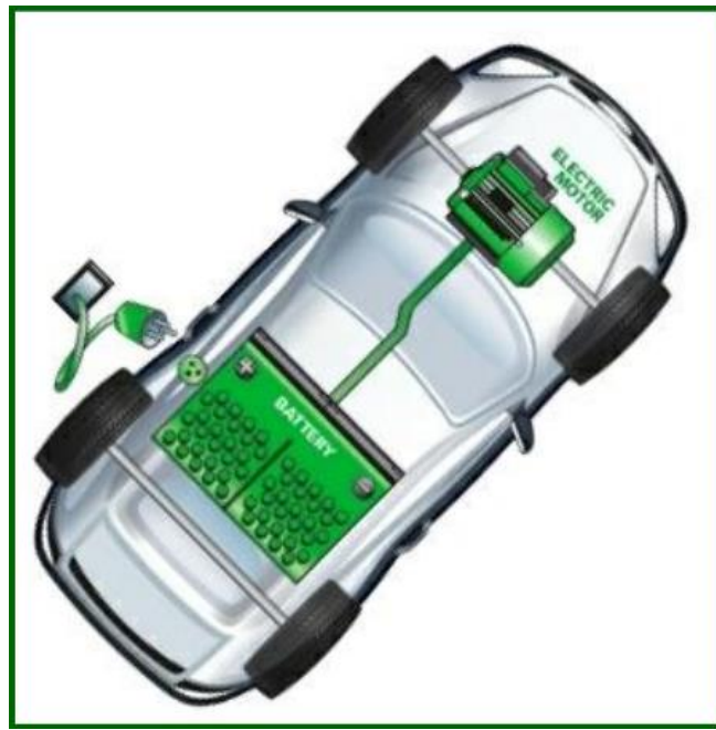
Εικόνα 3.7: Στοιχειώδη μέρη ενός B.E.V[29].
