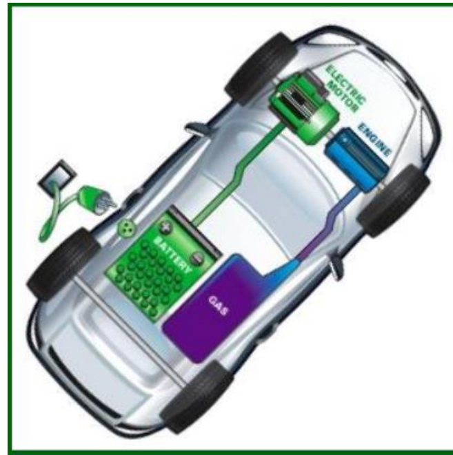
Εικόνα 3.4: Στοιχειώδη μέρη ενός P.H.E.V[29].
