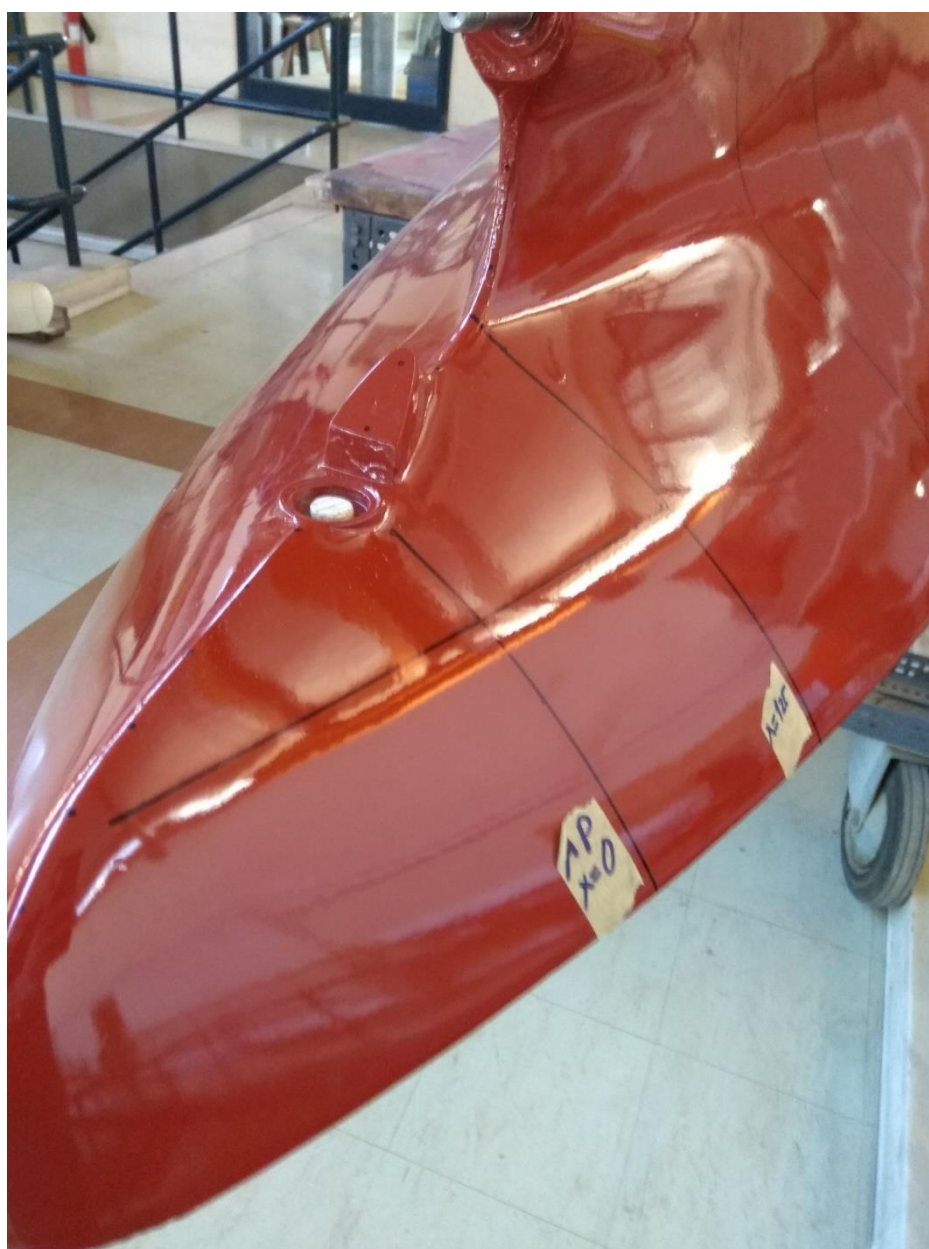
Εικόνα 4.3.1: Το μοντέλο μετά τις επισκευές. Διακρίνονται η ίσαλος και οι νομείς.
