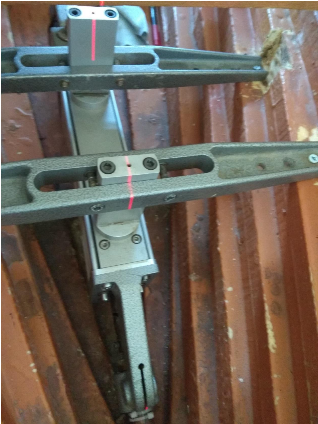
Εικόνα 4.3.2: Ευθυγράμμιση του δυναμόμετρου ροπής-ώσης με χρήση δέσμης λέιζερ.
