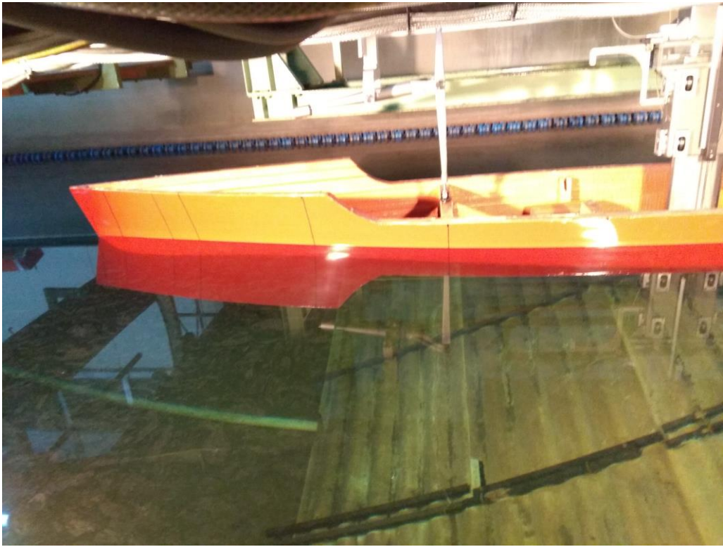
Εικόνα 4.4.1: Πειράματα αντίστασης. Στα δεξιά το δυναμόμετρο αντίστασης στο φορείο της δεξαμενής
