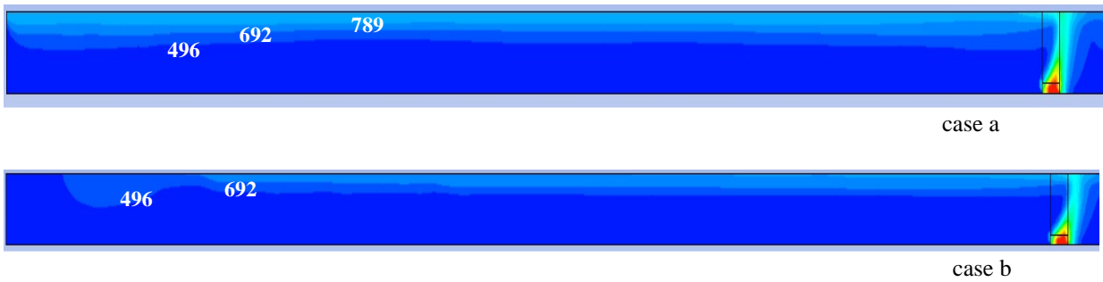
Εικόνα 5.10 Αντίθετη ροή του ζεστού αέρα
