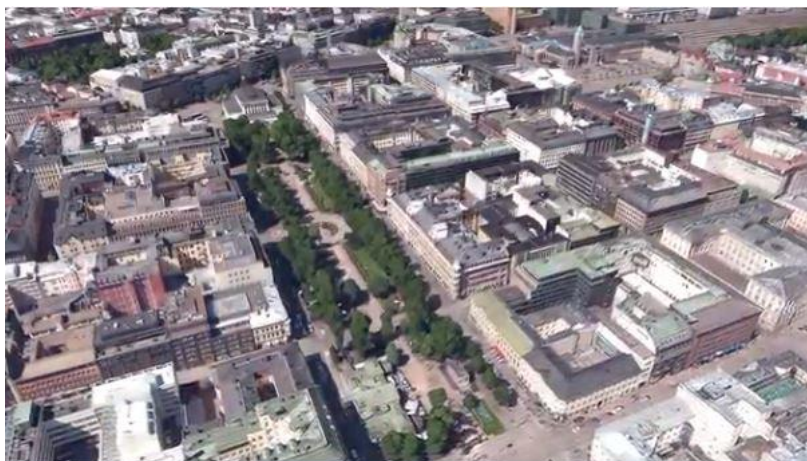
Εικόνα 19 - Στιγμιότυπο από το πρόγραμμα Helsinki 3D+ με χρήση ContextCapture (Πηγή: www.bentley.com )
