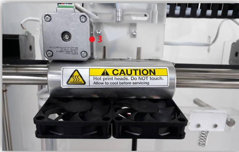
Σχήμα 4.2: Οι τρεις θέσεις μετρήσεως θερμοκρασίας (1,2: επάνω, 3: κάτω)
