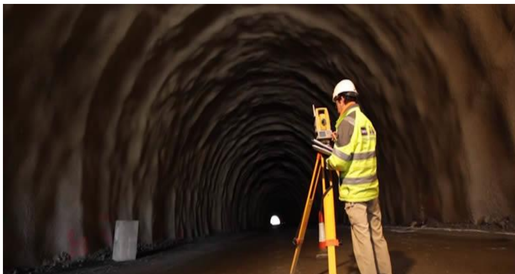
Εικόνα 2.14 : Έλεγχος μικρομετακινήσεων με τοπογραφικές μεθόδους (total station και reflex targets) ( Πηγή: https://www.aplitop.com/tunnels )
