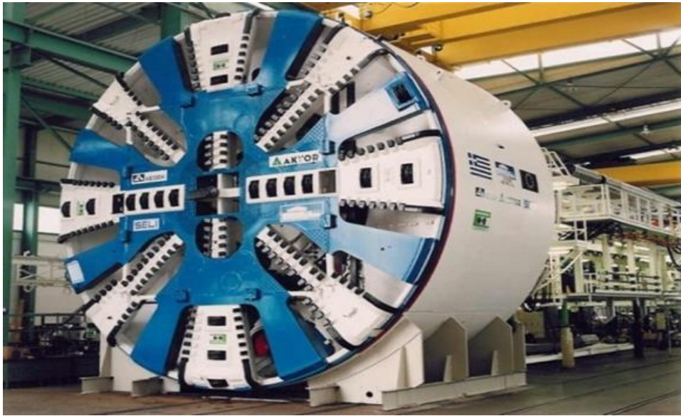
Εικόνα 2.2 : Μηχάνημα Διάνοιξης Σηράγγων TBM στο metro της Θεσσαλονίκης (Πηγή : https://www.ametro.gr/?page_id=378 )
