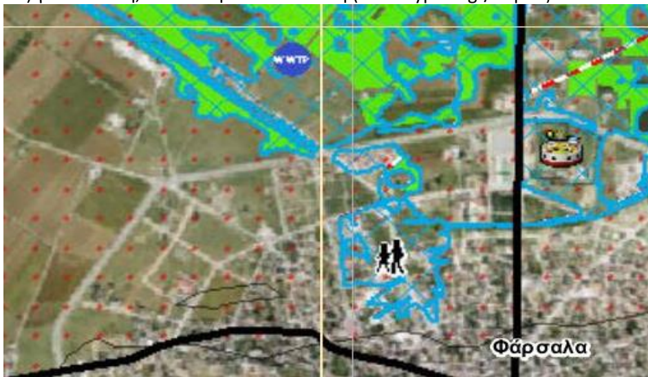
Εικόνα 2.2.9-4 ΕΕΛ σε Ζώνες Δυνητικά Υψηλού Κινδύνου Πλημμύρας του Υ.Δ. Θεσσαλίας (ΕΕΛ ΦΑΡΣΑΛΩΝ) για T=50έτη, T=100έτη και T=1000έτη (floods.greka.gr/Χάρτες Κινδύνων Πλημμύρας)
