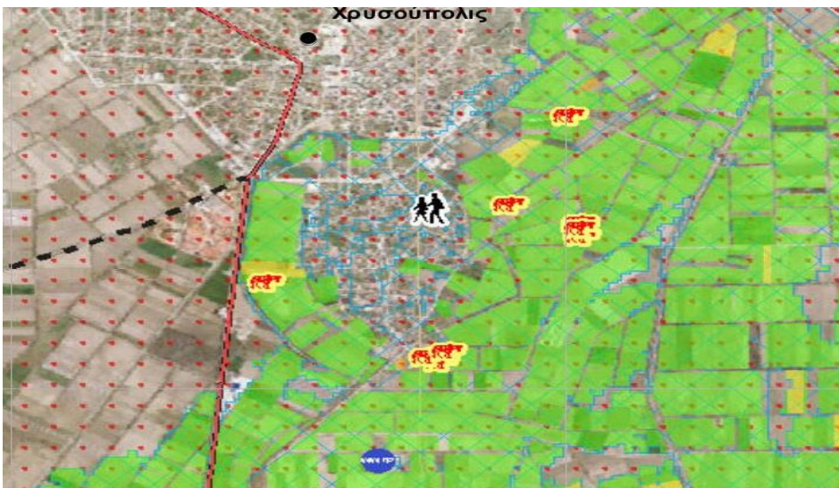
Εικόνα 2.2.13-6 ΕΕΛ σε Ζώνες Δυνητικά Υψηλού Κινδύνου Πλημμύρας του Υ.Δ. Θράκης (ΕΕΛ ΧΡΥΣΟΥΠΟΛΗ) για T=1000έτη (floods.ypeka.gr/Χάρτες Κινδύνων Πλημμύρας)
