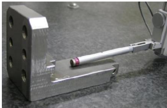
Εικόνα 20 Φορητό όργανο μέτρησης τραχύτητας
