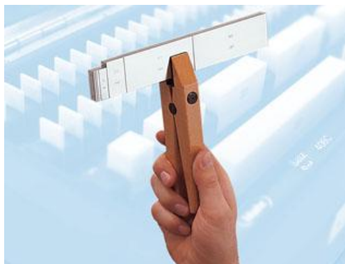
Εικόνα 30 Συνδυασμός πρότυπων πλακιδίων
