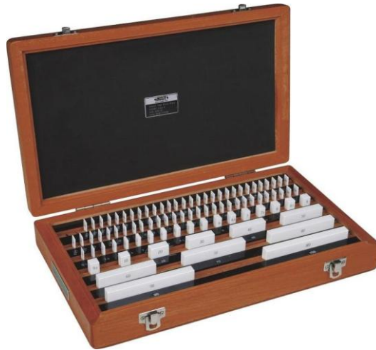
Εικόνα 29 Συλλογή πρότυπων πλακιδίων.
