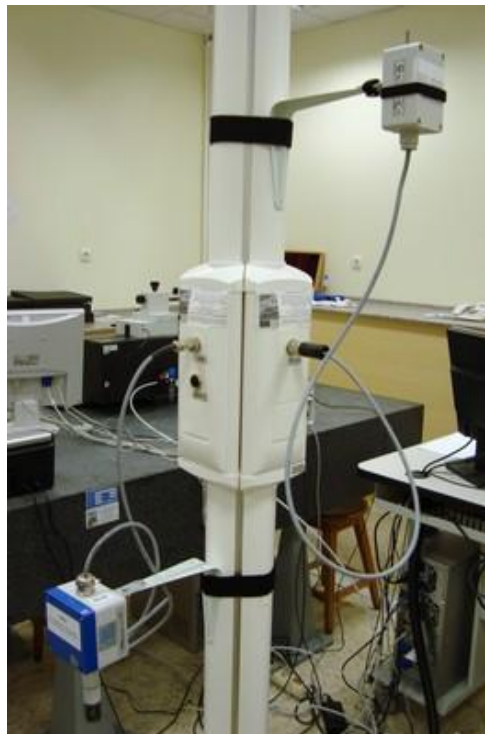
Εικόνα 16 Κεντρική στήλη αισθητήρων. Αντίστοιχες στήλες και αισθητήρες υπάρχουν περιμετρικά του χώρου. (Φωτογραφία από το site του εργαστηρίου)
