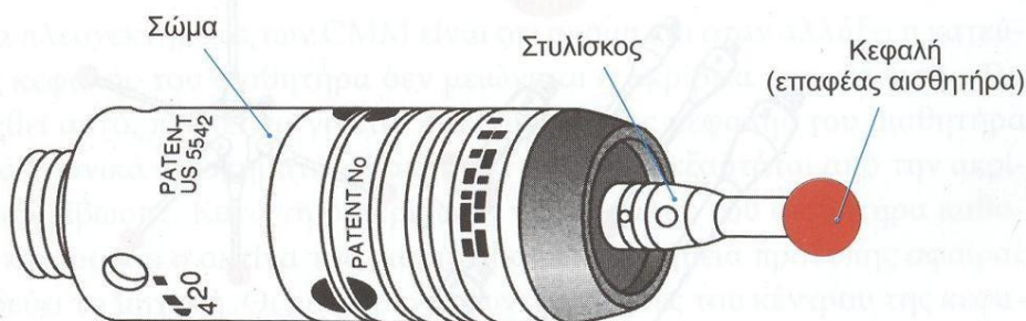
Εικόνα 2 Δομή αισθητήρα επαφής (Μανσούρ & Καραχάλιου, 2007)
