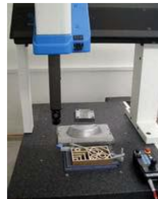
Εικόνα 18 Μηχανή Μέτρησης Συντεταγμένων CMM στο ΤΚΠ/ΤΚΕ
