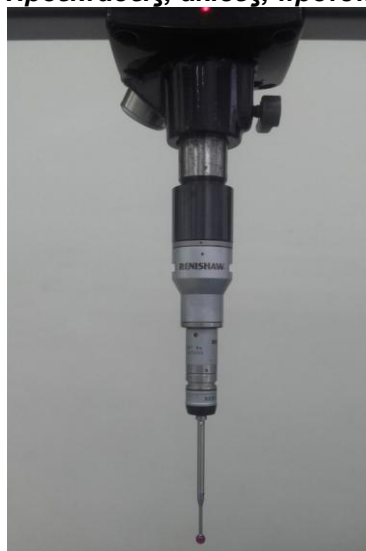
Σχήμα 2: Συγκρότημα κεφαλής – διαμόρφωσης – ακίδας
