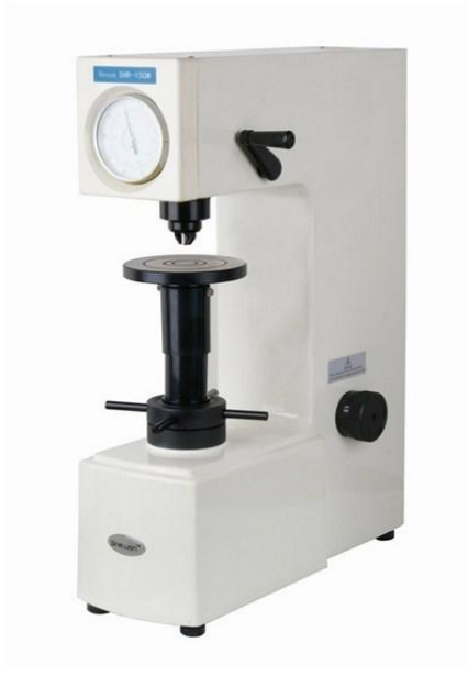
Εικόνα 22 Σταθερό Σκληρόμετρο Rockwell της Innovatest
