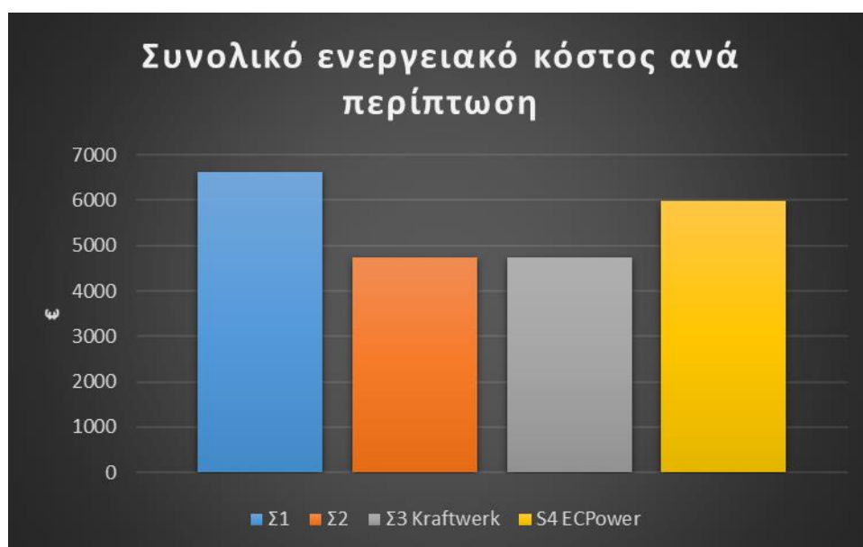
Σχήμα 59 Συνολικό ενεργειακό κόστος ανά περίπτωση με μείωση κόστους αγοράς ηλεκτρισμού από το δίκτυο της ΔΕΗ κατά 30%
