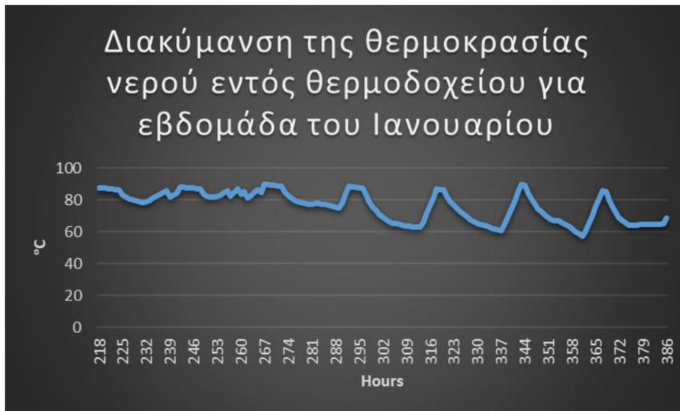
Σχήμα 43 Διακύμανση της θερμοκρασίας νερού εντός θερμοδοχείου για εβδομάδα του Ιανουαρίου
