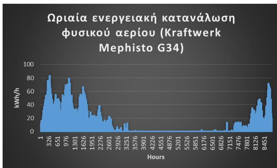
Σχήμα 38 Ωριαία ενεργειακή κατανάλωση φυσικού αερίου (Kraftwerk Mephisto G34)
