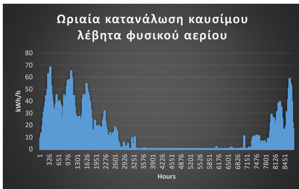
Σχήμα 36 Ωριαία κατανάλωση καυσίμου λέβητα φυσικού αερίου
