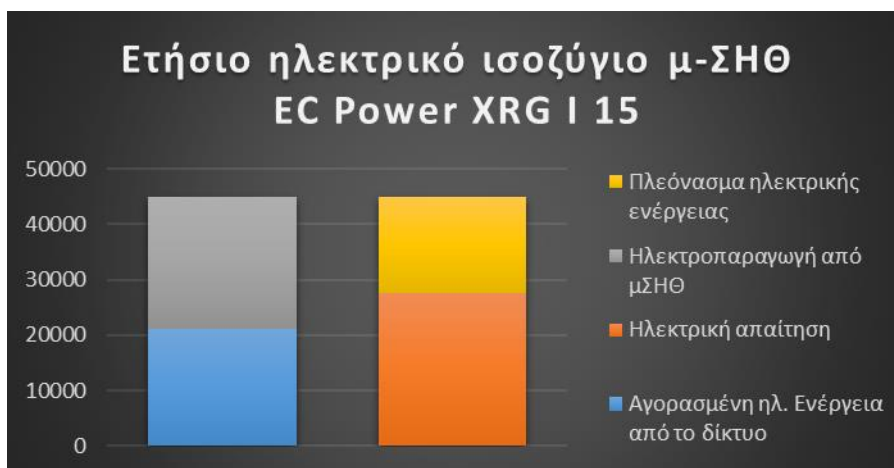
Σχήμα 48 Ετήσιο ηλεκτρικό ισοζύγιο μ-ΣΗΘ EC Power XRG I 15
