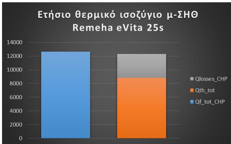
Σχήμα 41 Ετήσιο θερμικό ισοζύγιο μ-ΣΗΘ Remeha eVita 25s
