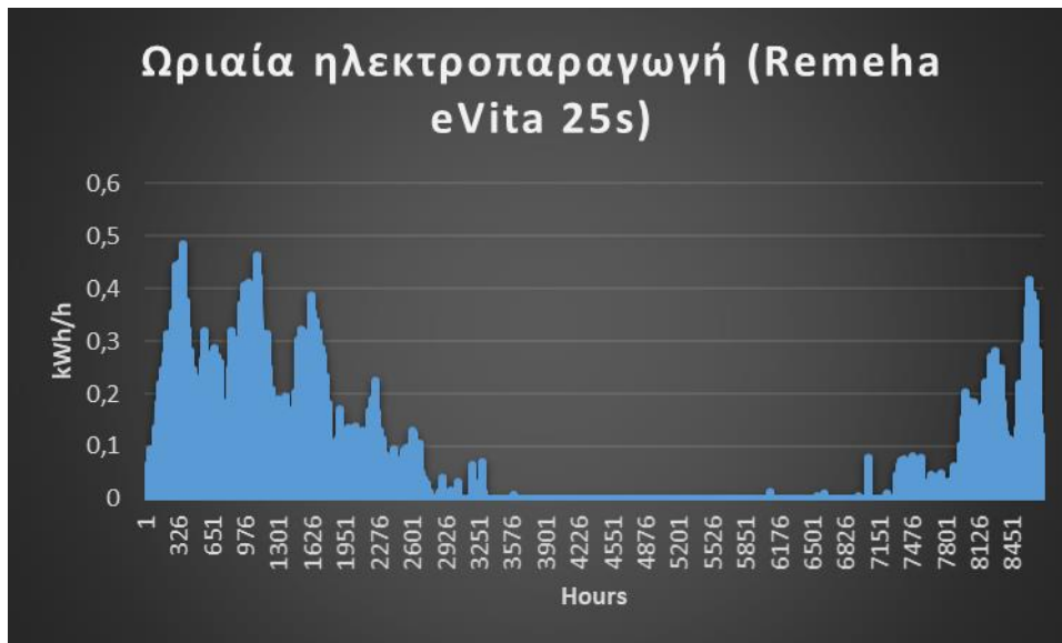
Σχήμα 40 Ωριαία ηλεκτροπαραγωγή (Remeha eVita 25s)
