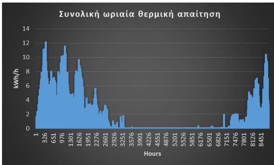
Σχήμα 33 Συνολική ωριαία θερμική απαίτηση
