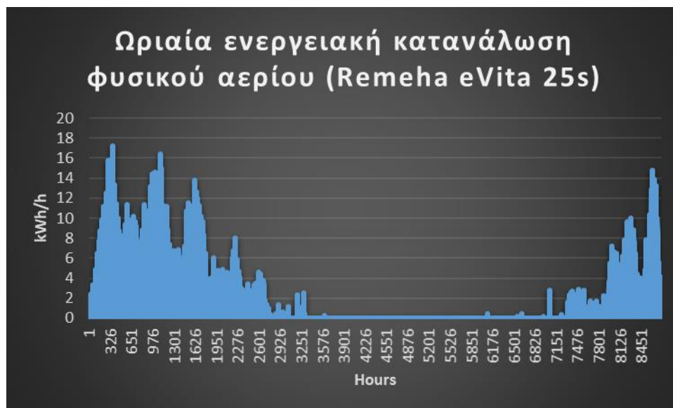
Σχήμα 39 Ωριαία ενεργειακή κατανάλωση φυσικού αερίου (Remeha eVita 25s)
