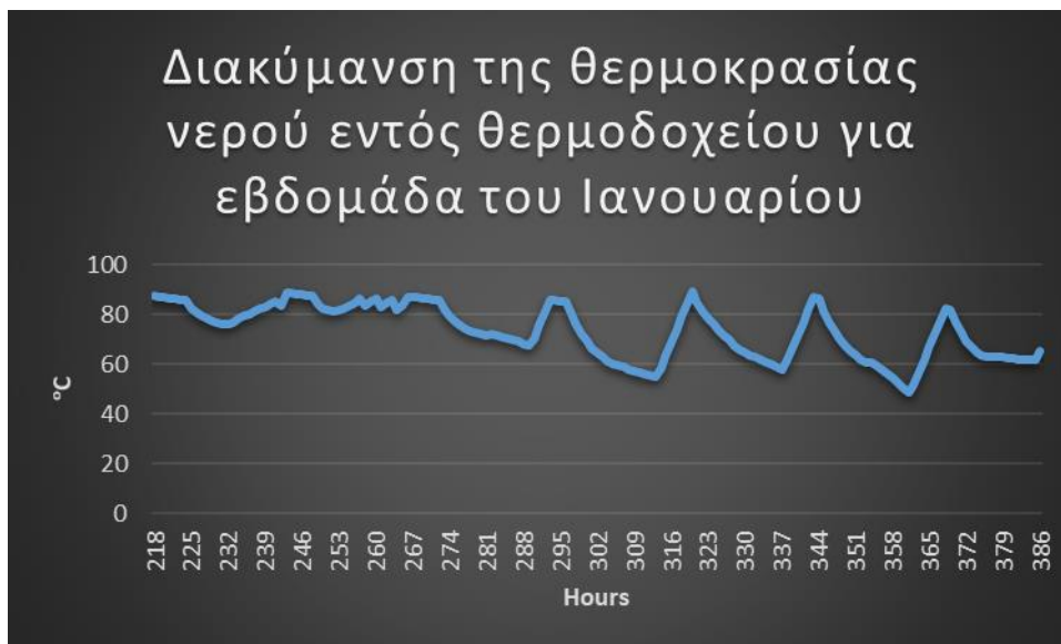
Σχήμα 48 Διακύμανση της θερμοκρασίας νερού εντός θερμοδοχείου για εβδομάδα του Ιανουαρίου
