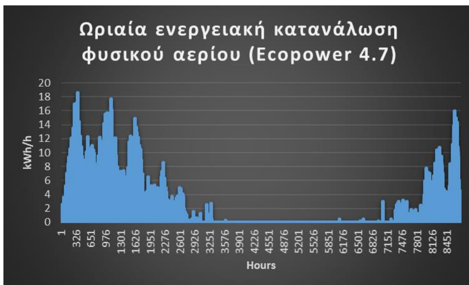
Σχήμα 43 Ωριαία ενεργειακή κατανάλωση φυσικού αερίου (Ecorpower 4.7)
