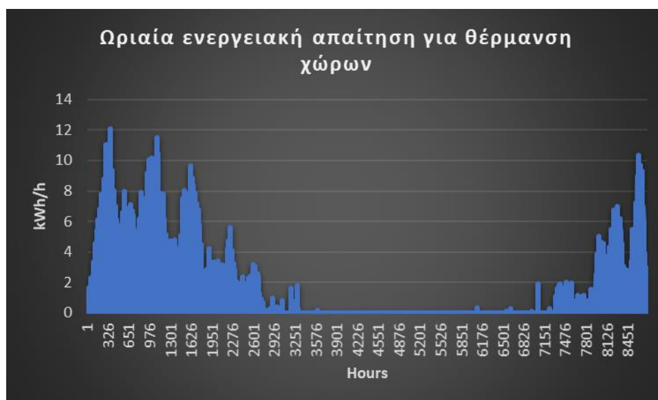
Σχήμα 31 Ωριαία ενεργειακή απαίτηση για θέρμανση χώρων
