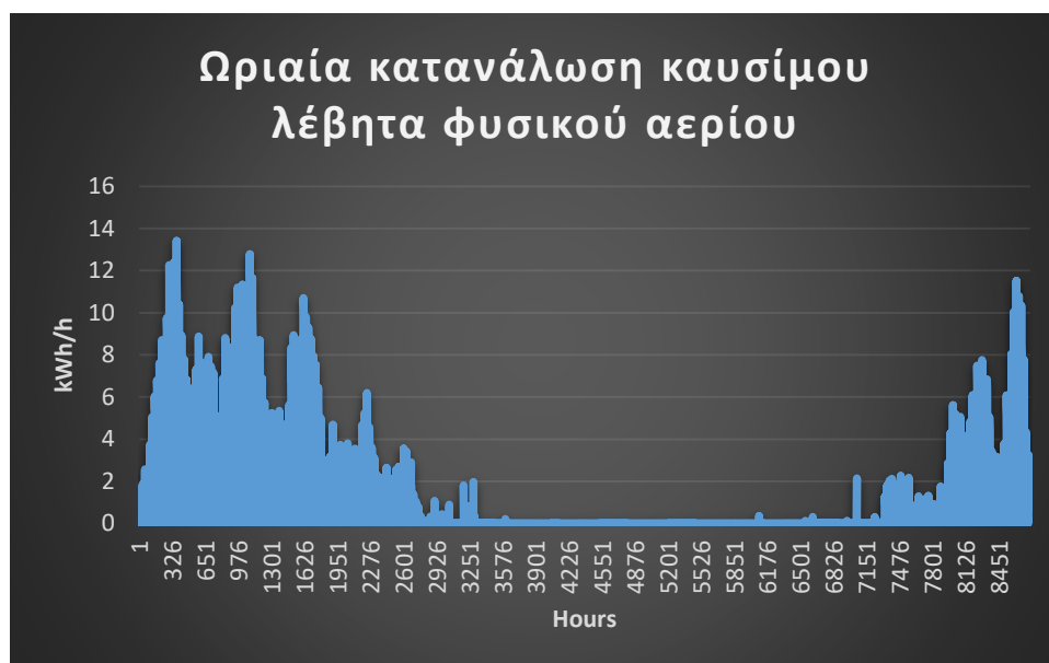
Σχήμα 37 Ωριαία κατανάλωση καυσίμου λέβητα φυσικού αερίου
