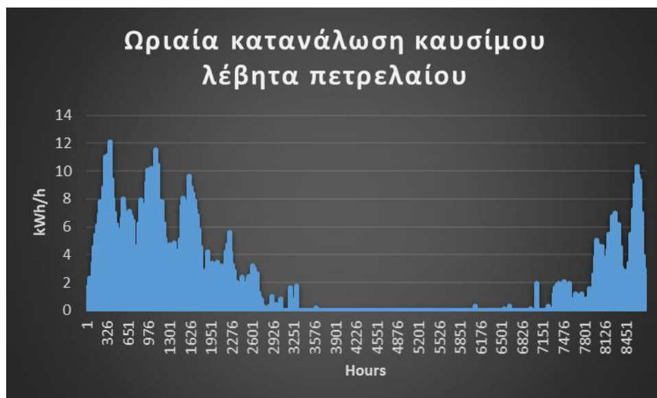
Σχήμα 35 Ωριαία κατανάλωση καυσίμου λέβητα πετρελαίου
