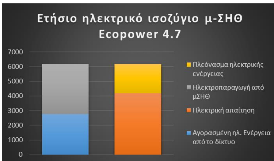
Σχήμα 46 Ετήσιο ηλεκτρικό ισοζύγιο μ-ΣΗΘ Ecorpower 4.7
