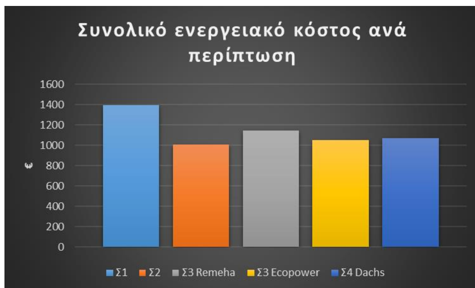
Σχήμα 59 Συνολικό ενεργειακό κόστος ανά περίπτωση
