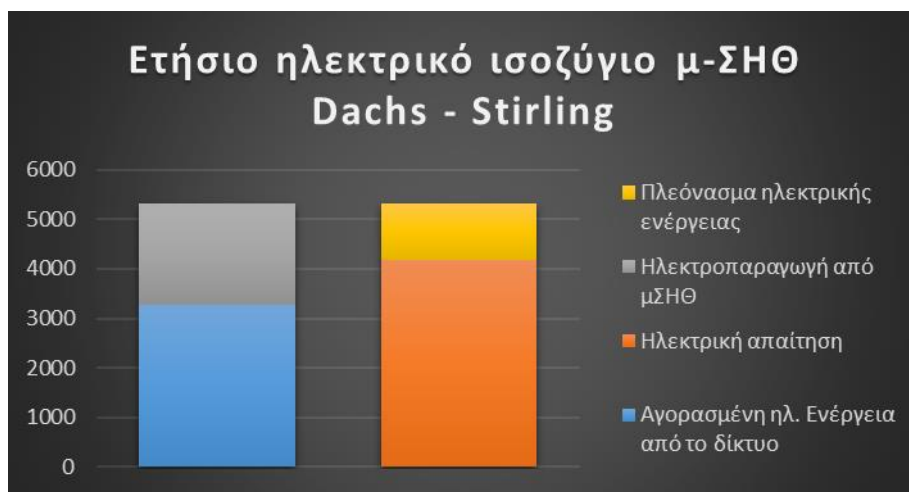
Σχήμα 53 Ετήσιο ηλεκτρικό ισοζύγιο μ-ΣΗΘ Dachs – Stirling
