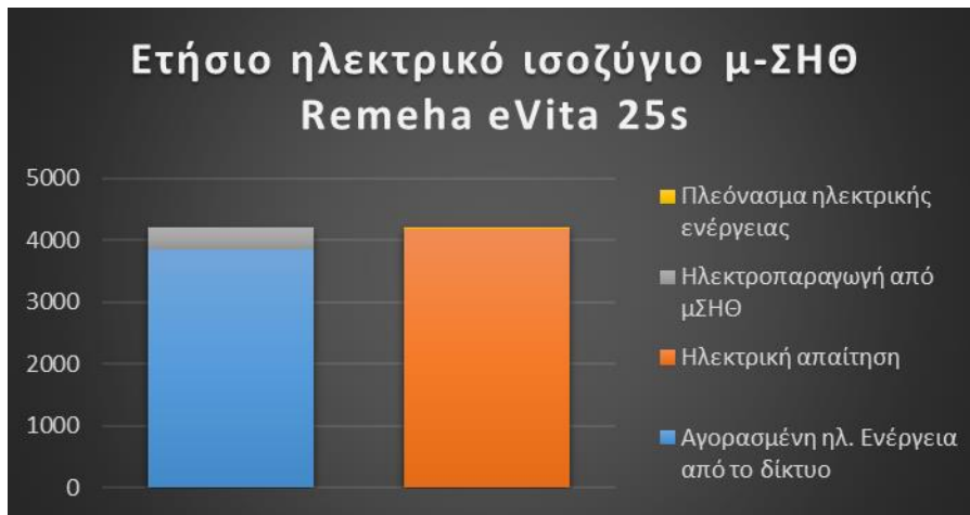
Σχήμα 42 Ετήσιο ηλεκτρικό ισοζύγιο μ-ΣΗΘ Remeha eVita 25s
