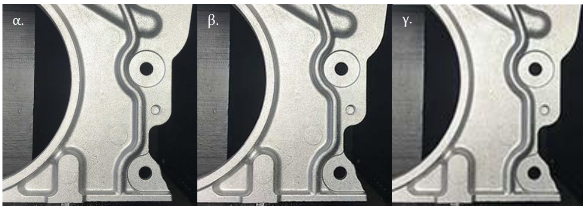
Εικόνα 54 Εικόνες εμπρός πλευράς με διαφορετική ανάλυση (α) 72 pixels/cm (β) 30 pixels/cm (γ) 20 pixels/cm
