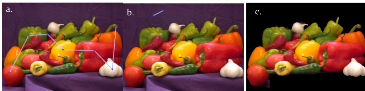
Εικόνα 29: Μέθοδος lazysnapping. (a) Επιλογή προσκήνιου (b) Επιλογή παρασκηνίου (c) Αποτέλεσμα
