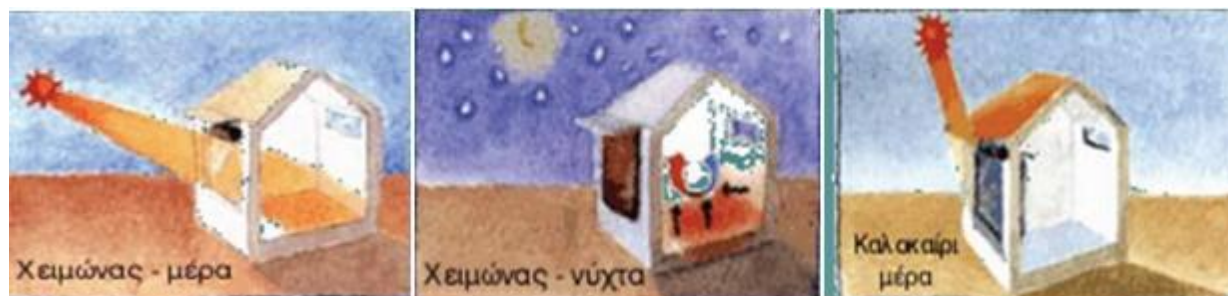
Εικόνα 1.3-1: Τρεις βασικές αρχές του βιοκλιματισμού: απρόσκοπτη είσοδος της ηλιακής ακτινοβολίας κατά τη διάρκεια της χειμερινής μέρας και διατήρηση της θερμότητας αυτής κατά τη διάρκεια της νύχτας, και επαρκής προστασία από την ηλιακή ακτινοβολία το καλοκαίρι 7
