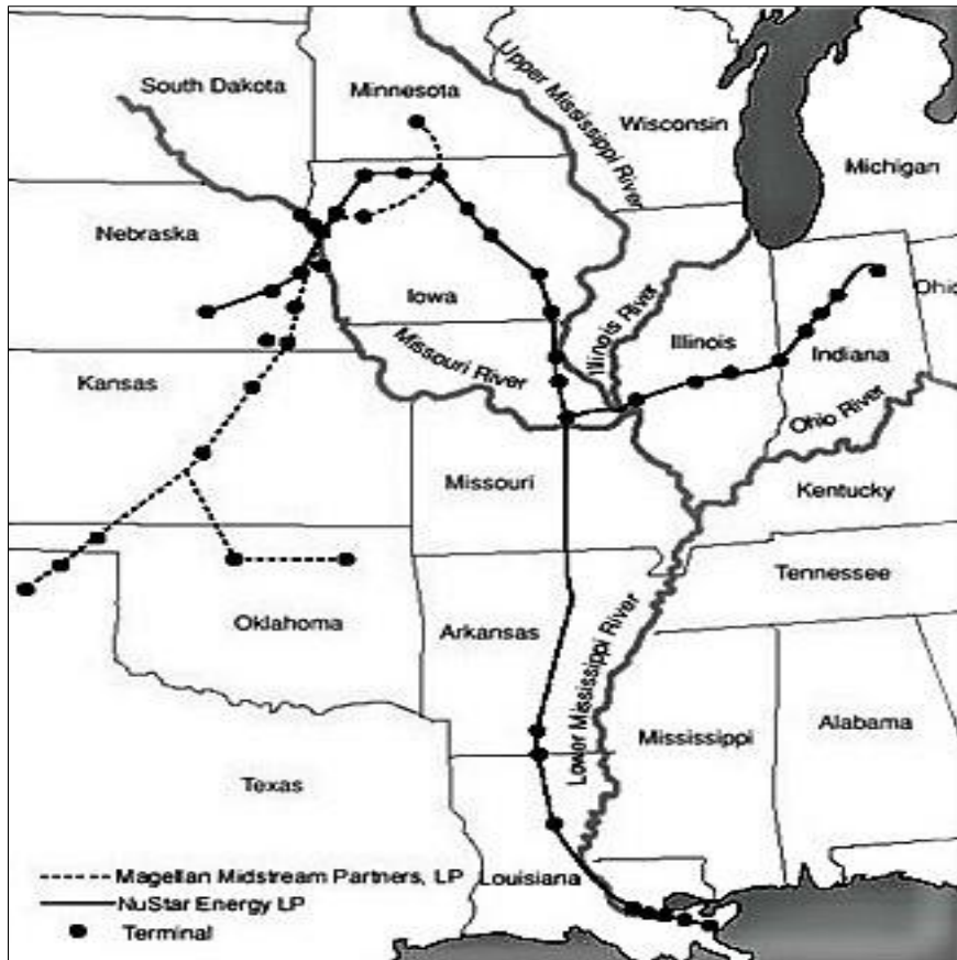
Εικόνα 2.3: Αγωγοί μεταφοράς αμμωνίας στις ΗΠΑ. Με τη συνεχή γραμμή απεικονίζεται ο αγωγός Nustar και με τη διακεκομμένη ο Magellan (Πηγή: energy.gov)
