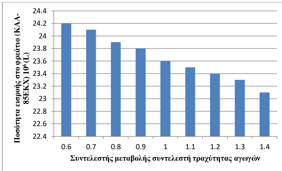
Εικόνα 7.14 Διάγραμμα συνολικής ποσότητας εισροής στο φρεάτιο ΚΑΑ-85ΕΚΧ ως προς τον συντελεστή η των αγωγών.
