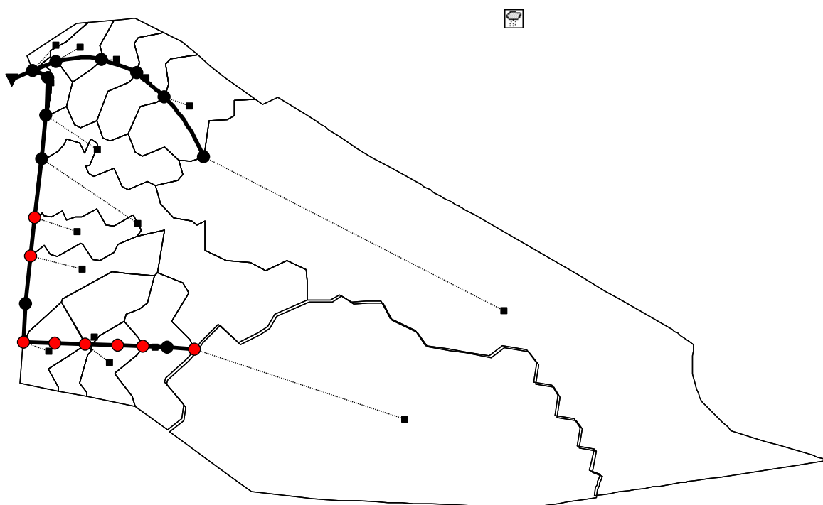
Εικόνα Δ.6 Πλημμυρισμένα φρεάτια τη χρονική στιγμή 6:01:00 για βροχόπτωση σχεδιασμού t=12 h και T=10 έτη. *όπως περιγράφεται η ονομασία των φρεατίων στην
