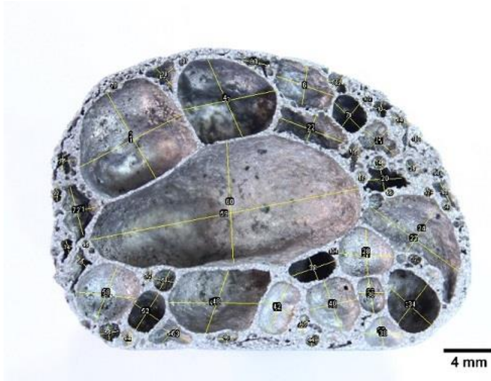
7.2.2 23 Καταμέτρηση πόρων και των διαμέτρων τους, Δοκίμιο 8 (5 % κ.β. Steel Flakes), Β όψη
