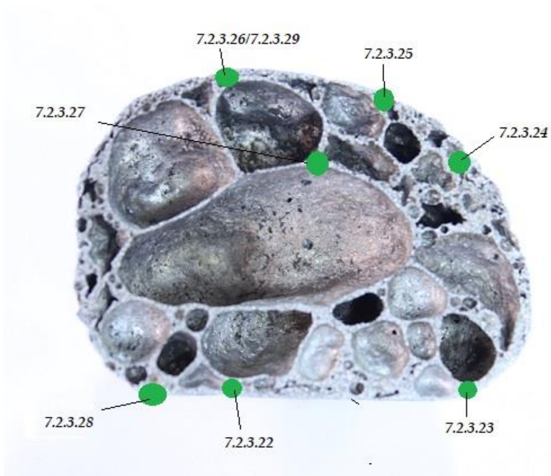
7.2.3 21 Σημεία μεγέθυνσης-λήψης στιγμιότυπων, Δοκίμιο 8 (5 % κ.β. Steel Flakes), Β Όψη
