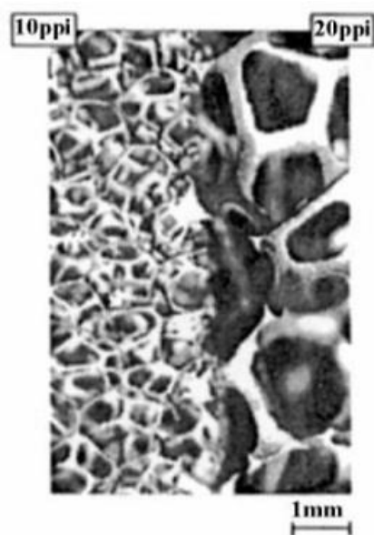
2.2.1.f2 Διεπιφάνεια μεταξύ δύο περιοχών διαφορετικού πορώδους. [21]
