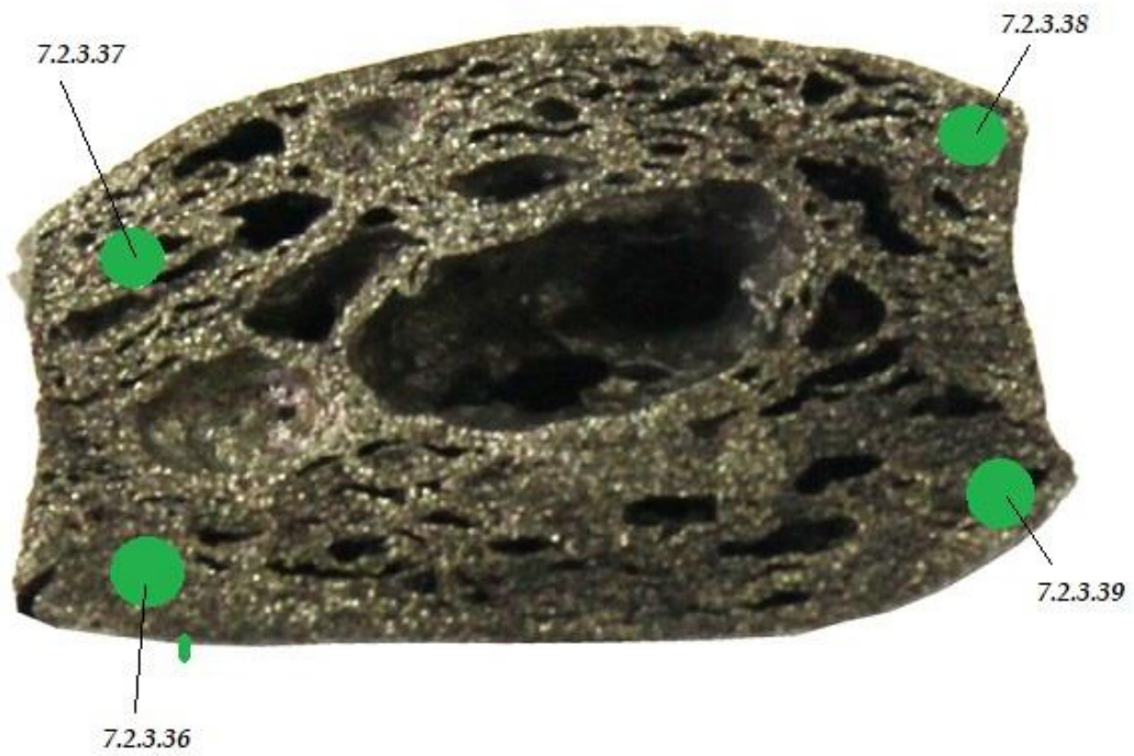
7.2.3 35 Σημεία μεγέθυνσης-λήψης στιγμιότυπων, Δοκίμιο 11 (10 % κ.β. Steel Flakes), Β Όψη
