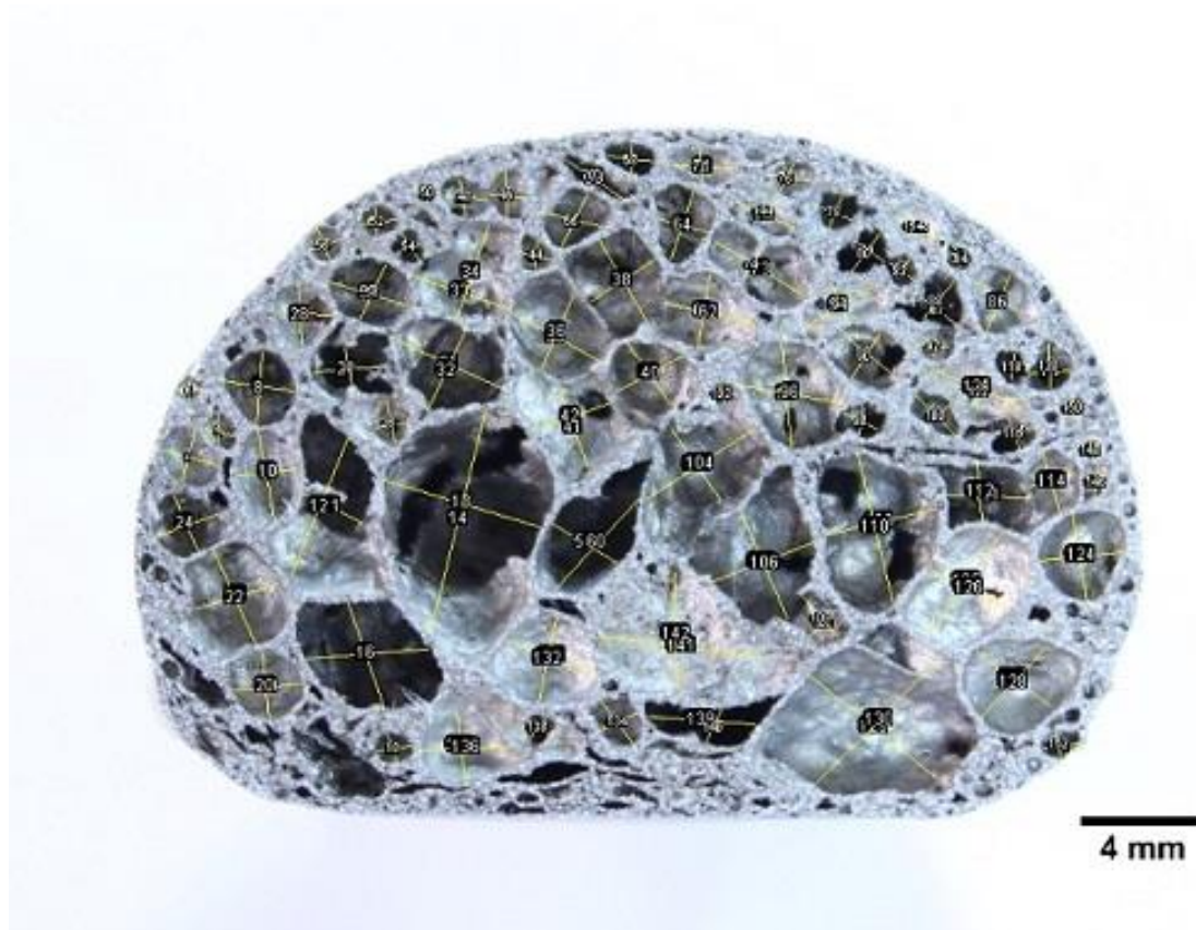
7.2.2 20 Καταμέτρηση πόρων και των διαμέτρων τους, Δοκίμιο 6 (2 % κ.β. Steel Flakes), Α όψη
