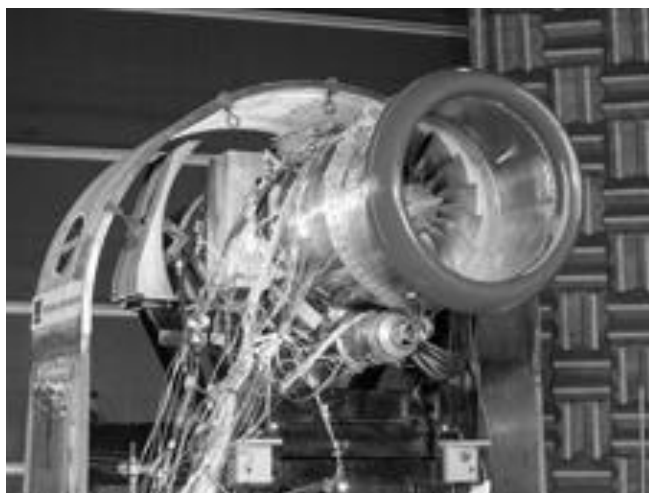
3.3.1.b 1 Διάταξη της NASA για μείωση του θορύβου από περίβλημα μεταλλικού αφρού. [40]
