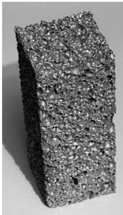
1.2 1 Μεταλλικός αφρός από αλουμίνιο [122]
