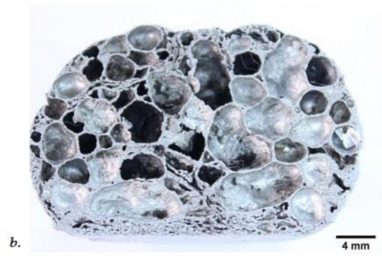
7.2.2 2 a. Α όψη, και b. Β όψη Δοκιμίου 2 (0 % κ.β. Steel Flakes)
