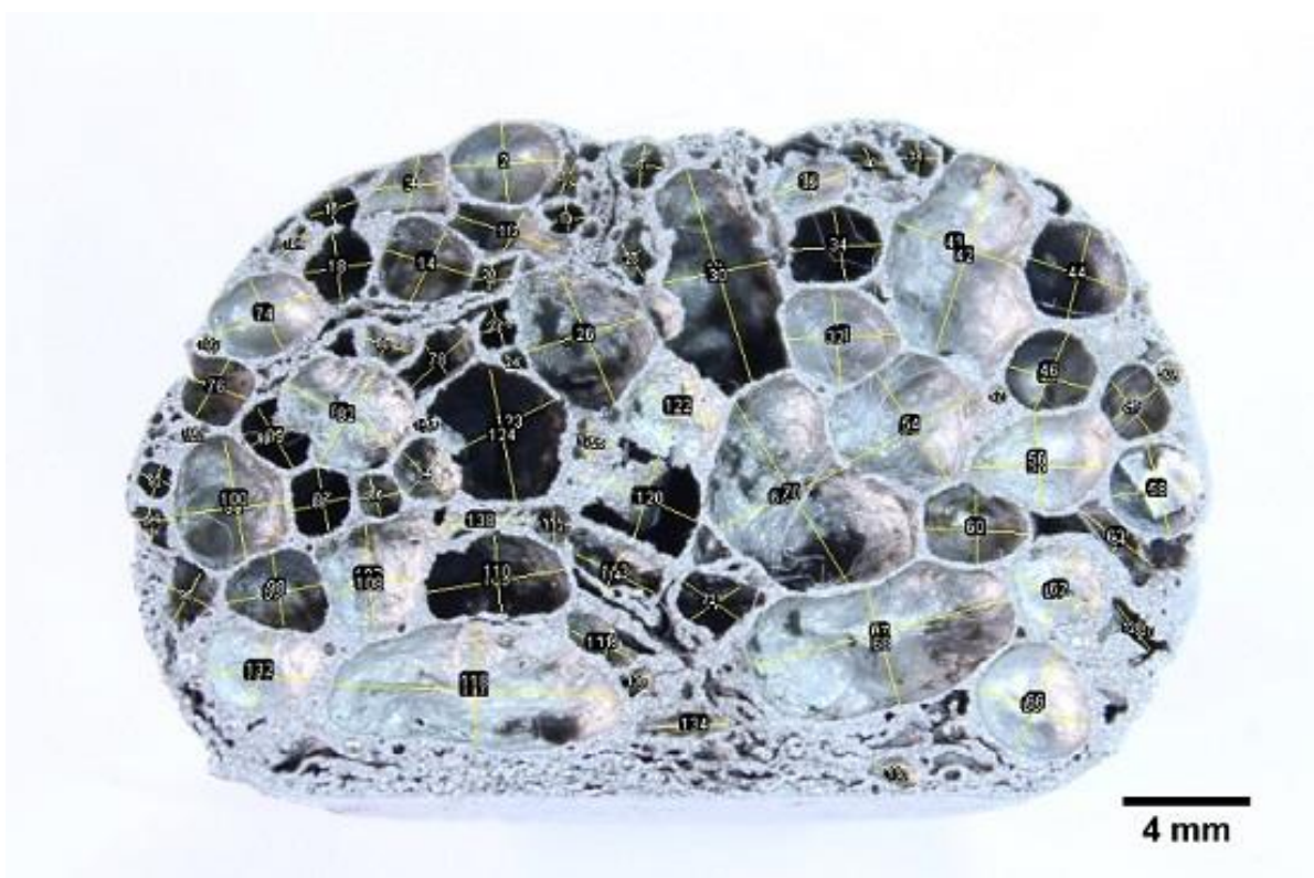
7.2.2 15 Καταμέτρηση πόρων και των διαμέτρων τους, Δοκίμιο 2 (0 % κ.β. Steel Flakes), 'B όψη
