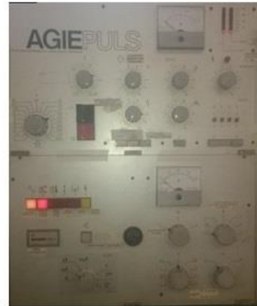
6.3.3 11 a. Διάταξη για την κατεργασία ηλεκτροδιάβρωσης EDM b. Πίνακας ελέγχου μηχανής με τις ρυθμίσεις που χρησιμοποιήθηκαν
