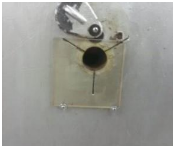
6.3.3 7 Το πυρίμαχο γυαλί που τοποθετήθηκε στη κεντρική οπή του φούρνου
