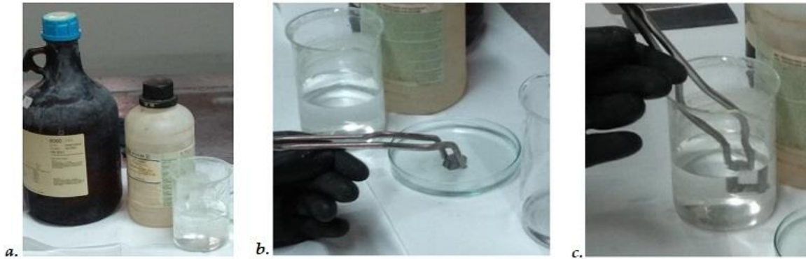
6.3.3 13 a. Νιτρικό οξύ και απιονισμένο νερό, b. Χημική προσβολή - Εμβάπτιση δοκιμίων στο νιτρικό οξύ, c. Καθαρισμός δοκιμίων στο απιονισμένο νερό
