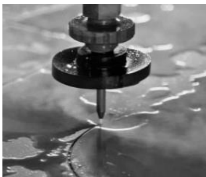
2.3.5 1 Κοπή δομής σάντουιτς από αφρό αλουμινίου με Jet νερού. [34]
