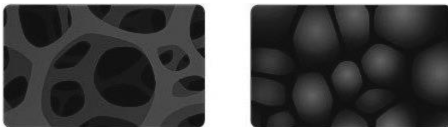
1.14 Κελιά ανοικτού (αριστερά) και κλειστού τύπου (δεξιά) [121]
