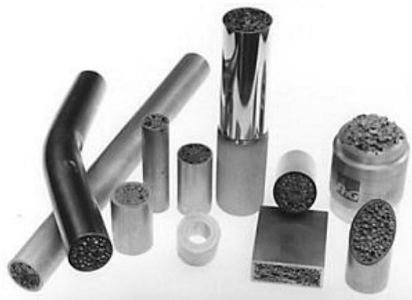
2.2.2.b 2 Σωλήνες γεμισμένοι με αφρό αλουμινίου. [24]
