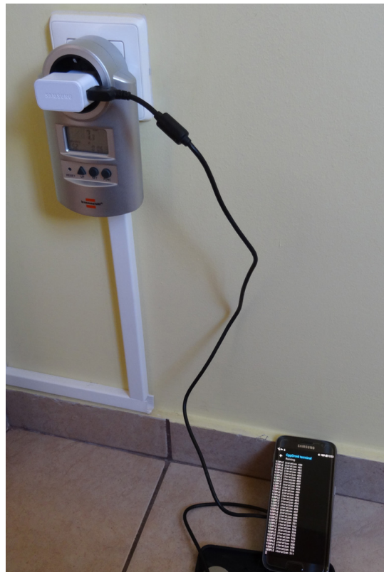
Εικόνα 10: Διάταξη για τη μέτρηση κατανάλωσης του Samsung Galaxy S7 κατά τη χρήση
