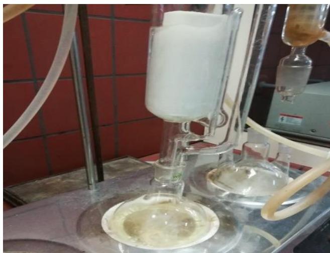
Εικόνα 4.1. Πειραματική διάταξη απελαίωσης πρώτης ύλης
