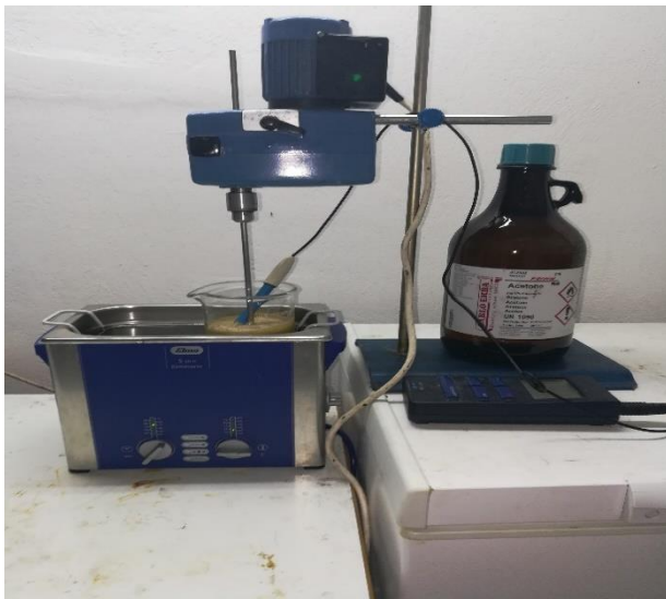
Εικόνα 4.2. Πειραματική διάταξη εκχύλισης με υπέρηχους
