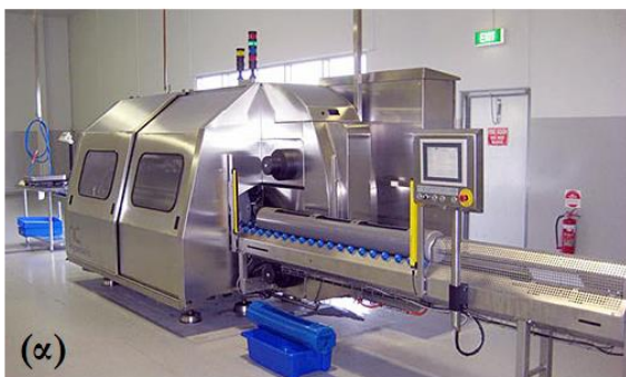
Εικόνα 2.1.5.1: Εξοπλισμός ΥΠ βιομηχανικής κλίμακας (α) οριζόντιας θέσης (Wave 600/55, NC Hyperbaric) και (β) κάθετης θέσης (215L-600 HPP System, Avure) (Γώγου, 2010).
