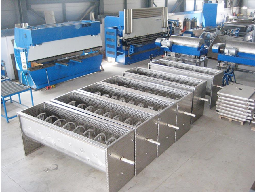
Εικόνα 1.3.3.1: Μαλακτήρας, όπου διακρίνονται ο άξονας και τα πτερυγία
