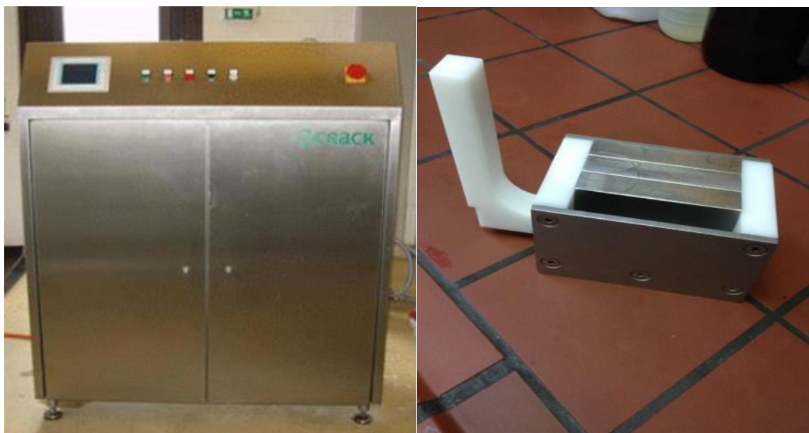
Εικόνα 3.3.5: Διάταξη του εξοπλισμού των Παλμικών Ηλεκτρικών Πεδίων (αριστερά), Θάλαμος διαλείποντος έργου για επεξεργασία με Παλμικά Ηλεκτρικά Πεδία (δεξιά)
