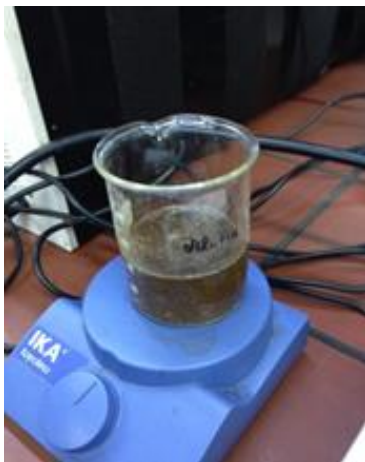
Εικόνα 3.4.1.1: Πειραματική διάταξη της εκχύλισης των ενδοκυτταρικών συστατικών του στερεού παραπροϊόντος της ελαιουργίας
