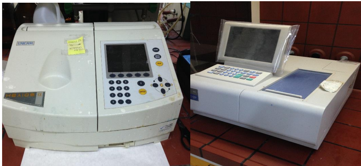
Εικόνα 3.3.7: Διάταξη του φασματοφωτόμετρου Helios α, UNICAM (αριστερά), Διάταξη του φασματοφωτόμετρου Hitachi U29000 (δεξιά)
