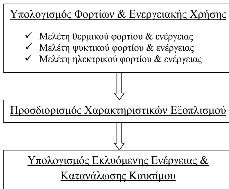
Σχήμα 2-2: Αλγόριθμος μοντέλου συμπαραγωγής RETScreen CHP
