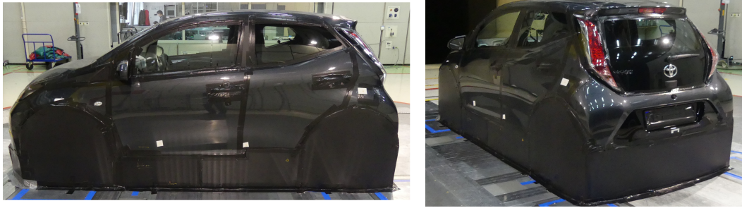
Σχήμα 7: Εφαρμογή σε αυτοκίνητο παραγωγής. Η προς μοντελοποίηση γεωμετρία του αυτοκινήτου, όπως μετρήθηκε στην αεροσύραγα.
