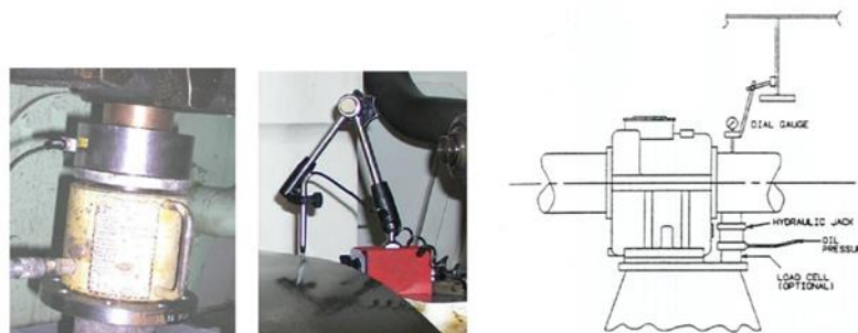
Σχήμα 3. 6: Μέτρηση αντιδράσεων με υδραυλικό γρύλο και ωρολογιακό μικρόμετρο. [15]
