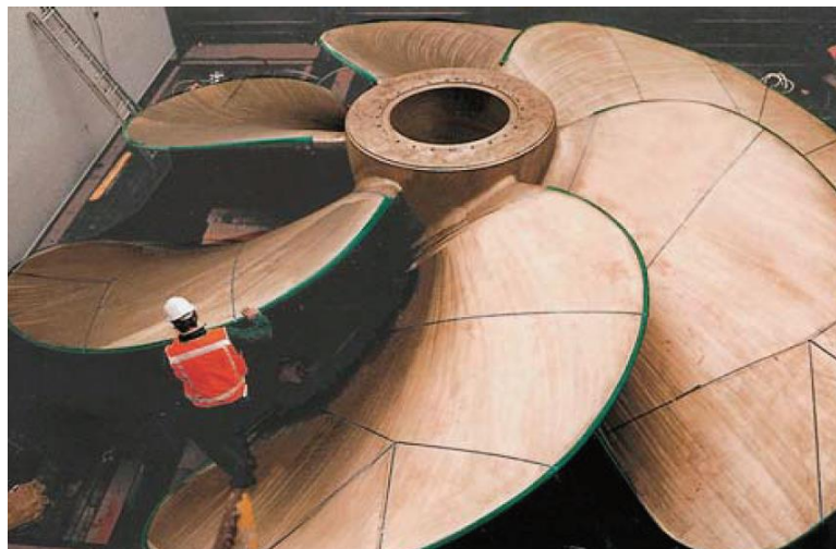
Σχήμα 2. 7: Έλικα σταθερού βήματος [10]
