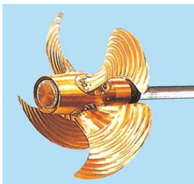
Σχήμα 2. 6: Έλικα μεταβλητού βήματος [10]
