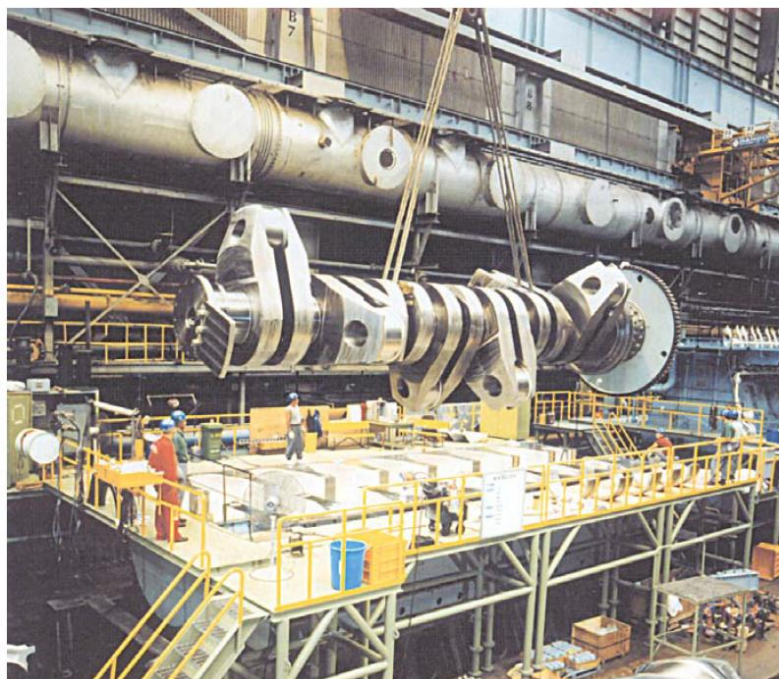
Σχήμα 2. 2: Στροφαλοφόρος άξονας μεγάλης δίχρονης πετρελαιομηχανής [9]
