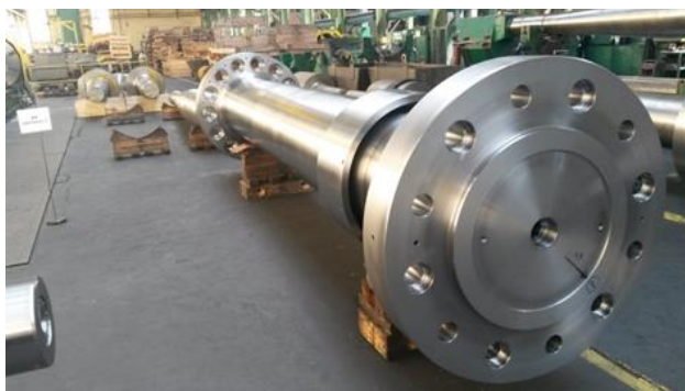
Σχήμα 2. 8: Τυπική μορφή ενδιάμεσου άξονα [9]
