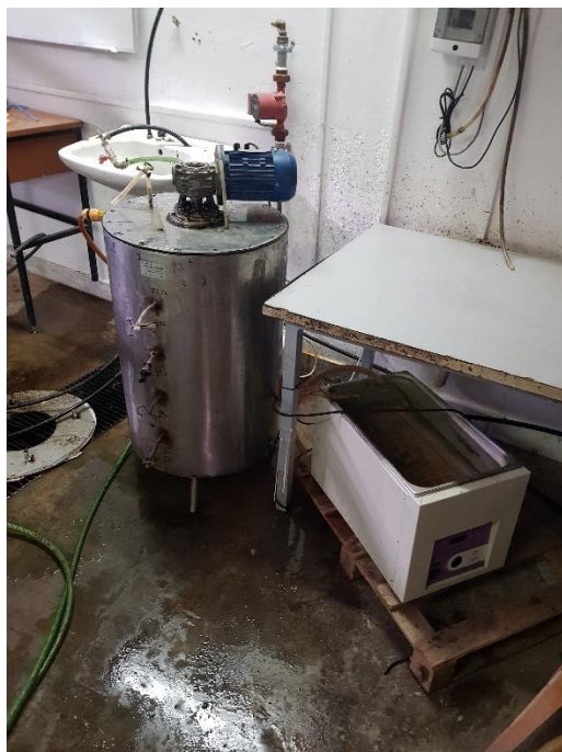
Εικόνα 19: Πειραματική διάταξη βιοαντιδραστήρων διαλείποντος έργου πιλοτικής κλίμακας
