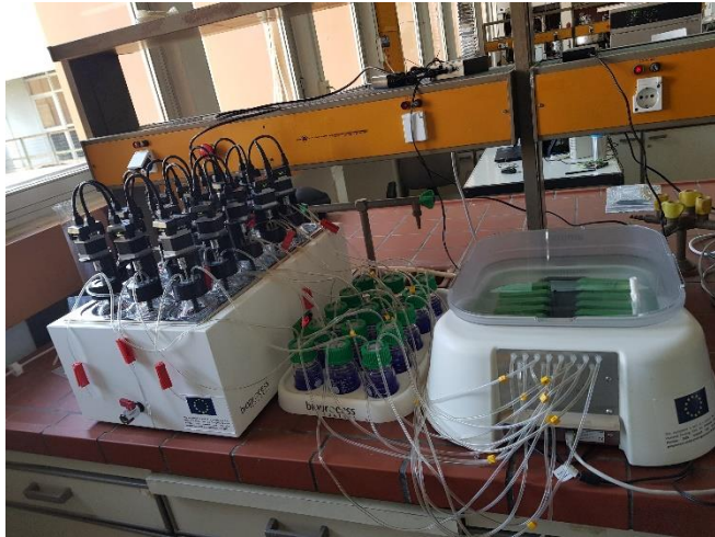
Εικόνα 18: Πειραματική διάταξη βιοαντιδραστήρων διαλείποντος έργου εργαστηριακής κλίμακας
