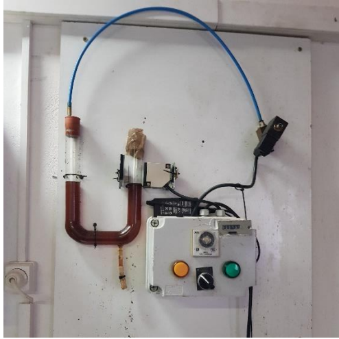
Εικόνα 15: Διάταξη μέτρησης παροχής βιοαερίου.
