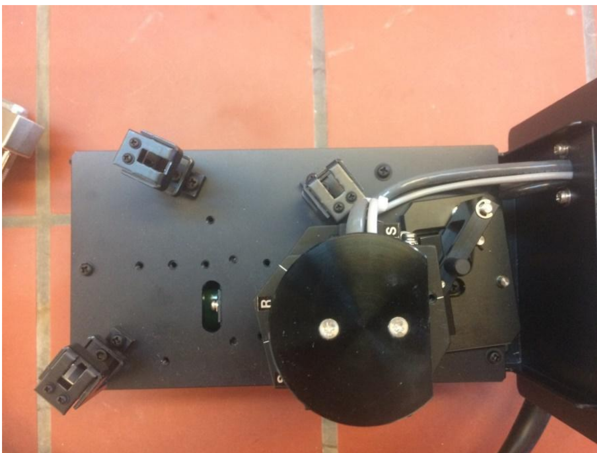
Εικόνα 4.10 Η σφαίρα ολοκλήρωσης που χρησιμοποιήθηκε στο πείραμα [38]
