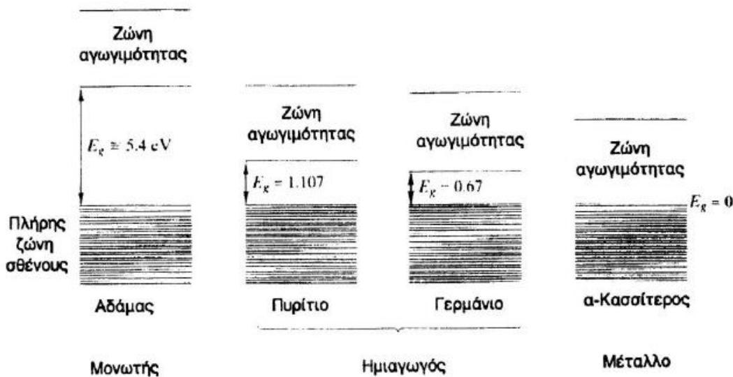
Εικόνα 1.5: Σχηματισμός ζωνών σθένους και αγωγιμότητας και τιμές των ενεργειακών διάκενων στα στοιχεία της ομάδας 14 του περιοδικού συστήματος που καθορίζουν την ηλεκτρική συμπεριφορά των υλικών [7]
