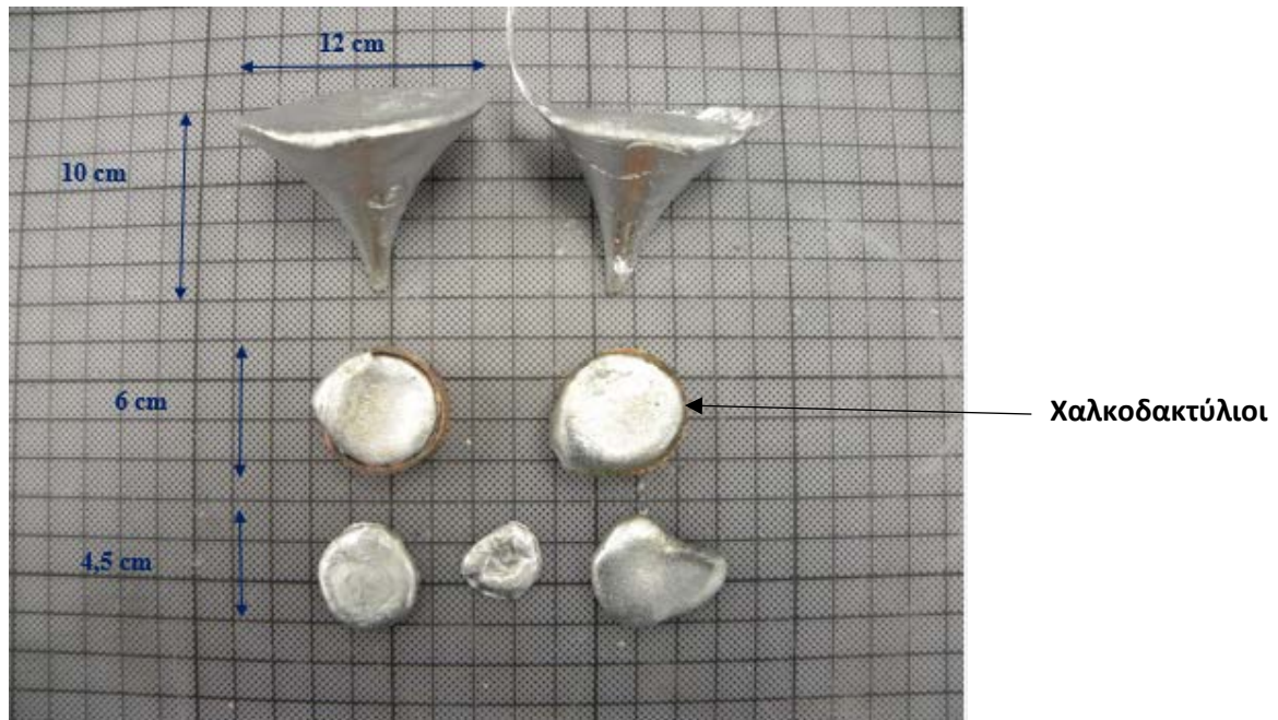
Φωτογραφία 5 από τα as cast προϊόντα της 4 ης χύτευσης από την οποία κόψαμε δοκίμια.
