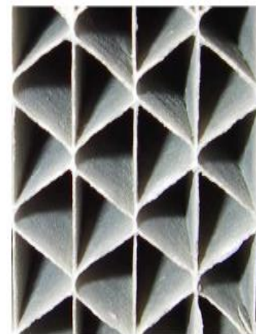
Εικόνα 2.6 : Παράδειγμα διατομής κουτιού καταλύτη τρίπλευρων εσωτερικών διαμορφώσεων [5].
