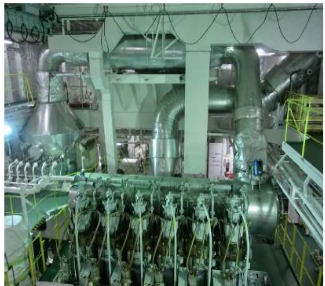
Εικόνα 2.20 : Εικόνα ναυτικού κινητήρα με σύστημα HP-SCR σε μηχανοστάσιο πλοίου [5].
