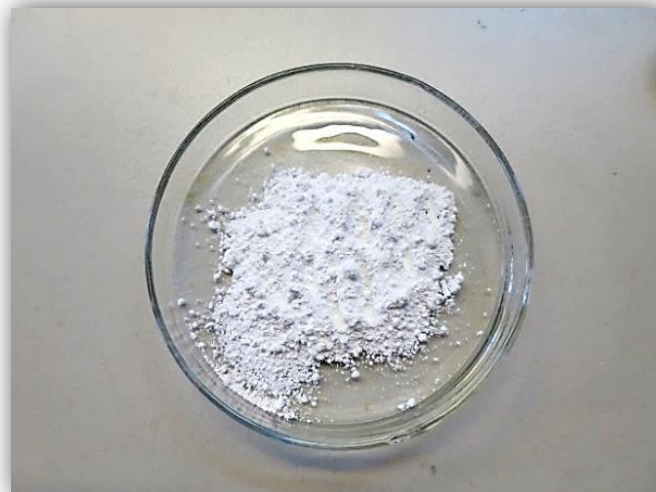
Εικόνα 7.1 Σκόνη εμπορικής ζιρκονίας (Sigma Aldrich, 99% trace metals basis)
