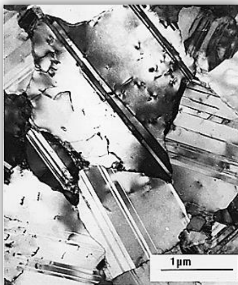
Εικόνα 3.8 Μικρογραφία TEM, σε οριζόντια τομή, αποθέματος προσανατολισμένου κατά τον άξονα [211] όπου διακρίνονται τα χαρακτηριστικά κάθετα επίπεδα διδυμίας [38,40]
