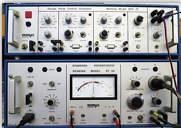
Εικόνα 7.7 Ποτενσιοστάτης (κάτω) και γεννήτρια παλμών (πάνω)
