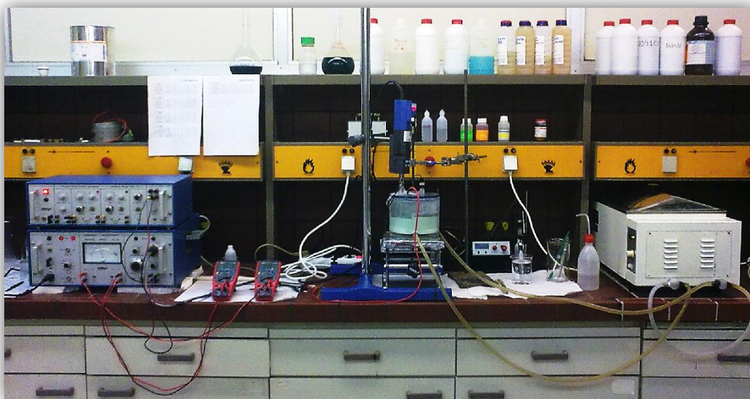
Εικόνα 7.6 Η πειραματική διάταξη που χρησιμοποιήθηκε για την παρασκευή των απλών αποθεμάτων Ni και των σύνθετων αποθεμάτων Ni/ZrO 2
