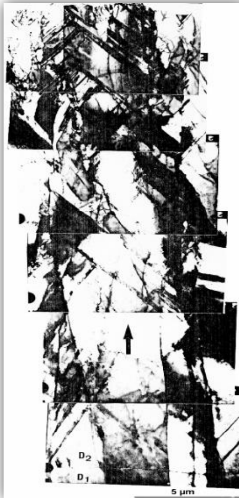
Εικόνα 3.4 Μικρογραφία TEM, σε κάθετη τομή, αποθέματος προσανατολισμένου κατά τον άξονα [100] [49]
