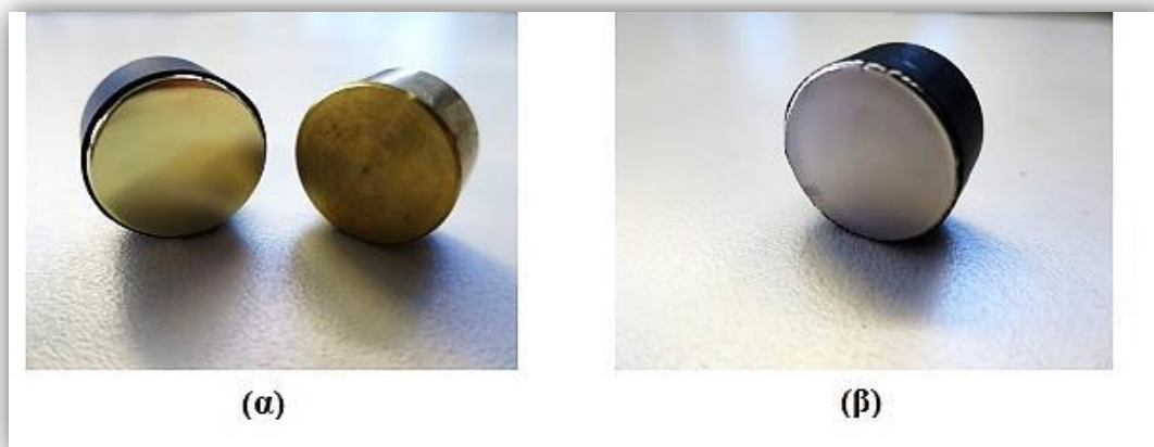
Εικόνα 7.5 Δοκίμια πριν (δεξιά) και μετά (αριστερά) από τη συνολική διαδικασία προκατεργασίας τους (α), επιμεταλλωμένο δοκίμιο (β)
