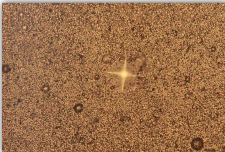
Εικόνα 7.9 Τετραγωνικό αποτύπωμα μέτρησης μικροσκληρότητας κατά Vickers, όπως απεικονίζεται σε μεγέθυνση 40× με τη βοήθεια οπτικού μικροσκοπίου Leitz Aristomet
