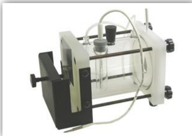
Εικόνα 7.10 Ηλεκτροχημικό κελί διάβρωσης τύπου flat-cell [63]
