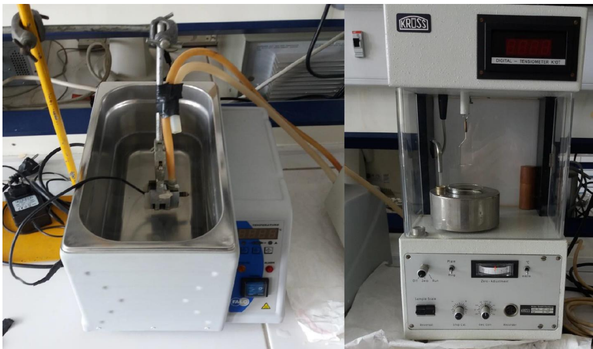
Εικόνα 16: Η διάταξη μέτρησης της επιφανειακής τάσης με τη μέθοδο Du Noüy.
