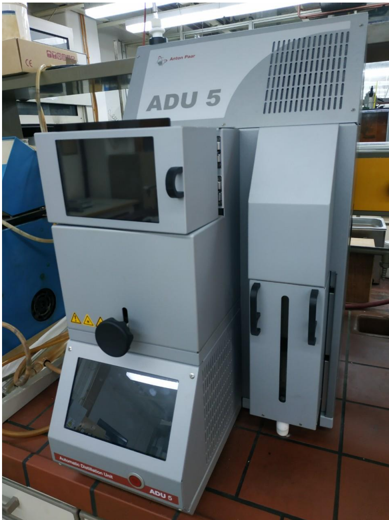
Εικόνα 12: Η συσκευή ατμοσφαιρικής απόσταξης.
