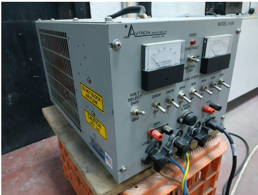
Εικόνα 24: Ο ρυθμιστής ωμικού φορτίου εναλλασσόμενου ρεύματος για την επιβολή φορτίου στη γεννήτρια και κατά συνέπεια, στον κινητήρα.
