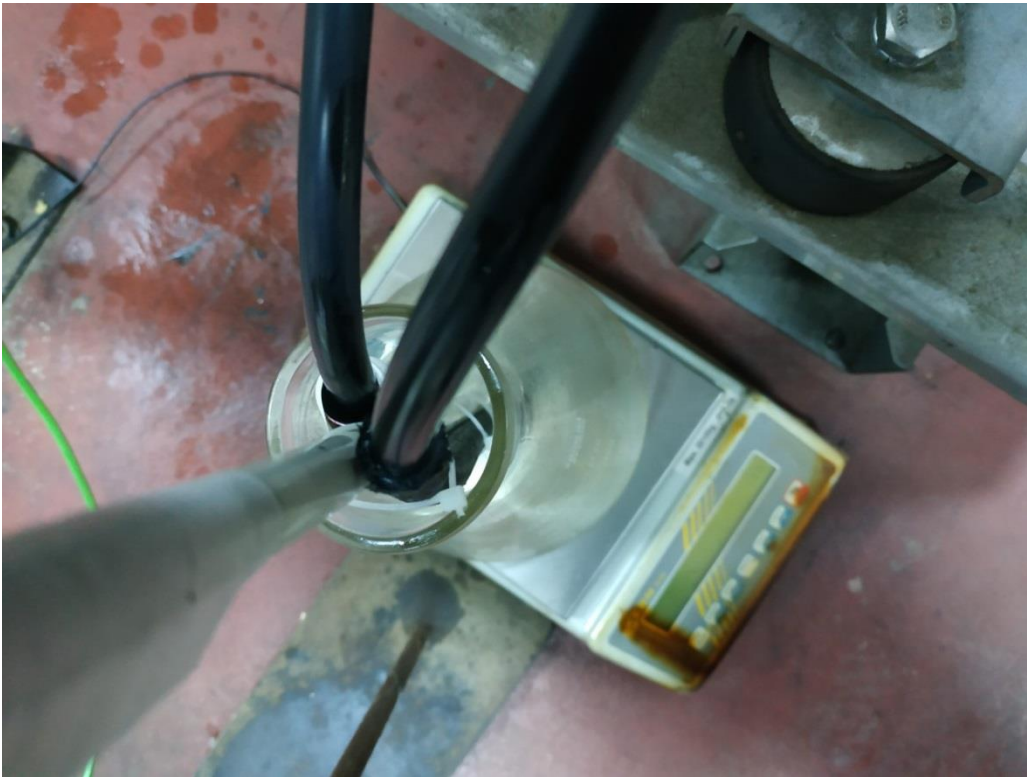
Εικόνα 25: Ο ζυγός μέτρησης κατανάλωσης καυσίμου με την αυτοσχέδια βάση στήριξης των αγωγών προσαγωγής και επιστροφής του καυσίμου.
