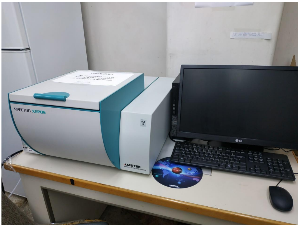
Εικόνα 13: Ο εξοπλισμός της μεθόδου EN ISO 20847 για τον προσδιορισμό υψηλών περιεκτικότητας σε θείο.
