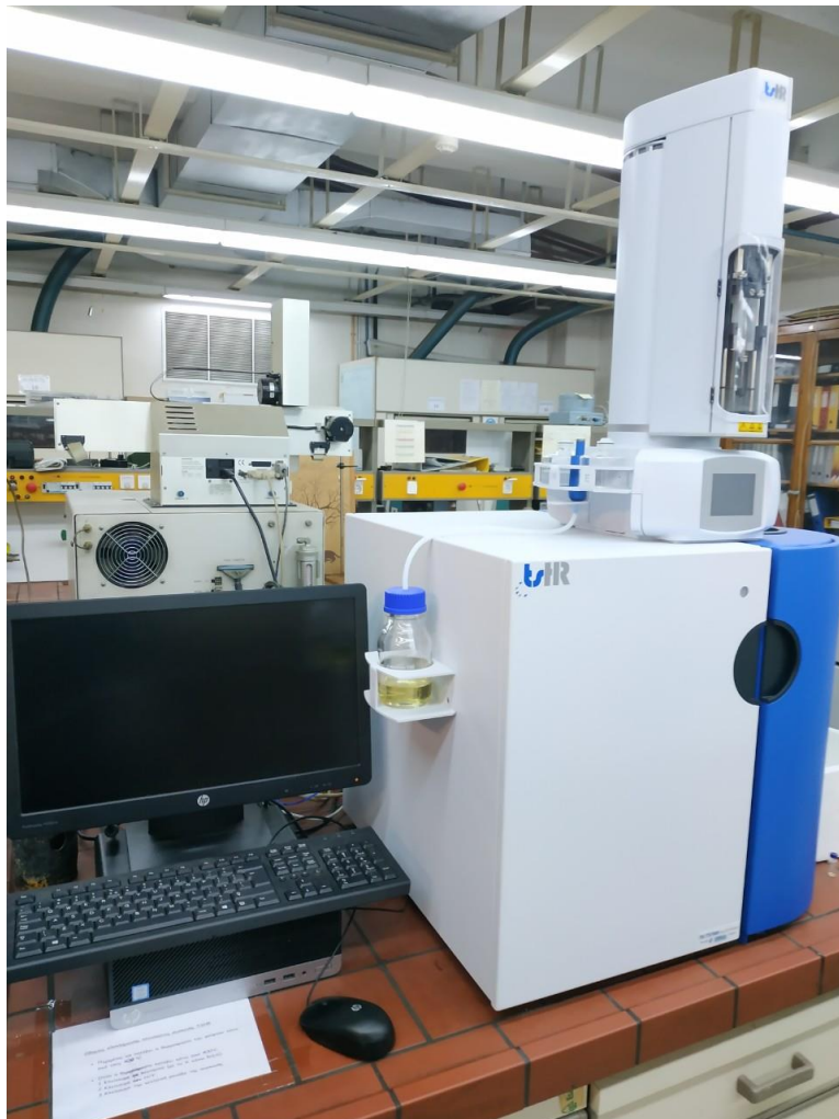
Εικόνα 14: Ο εξοπλισμός της μεθόδου EN ISO 20846 για τη μέτρηση περιεκτικότητας σε θείο καυσίμων ULSD.
