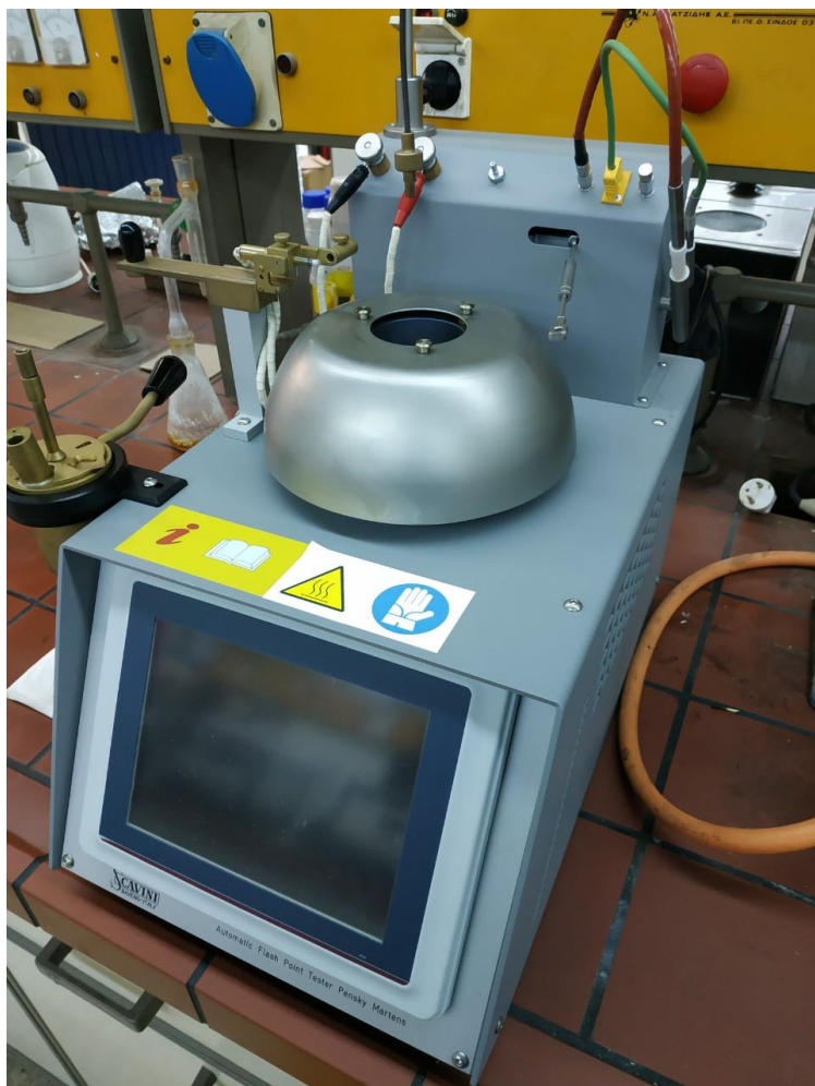
Εικόνα 15: Η συσκευή μέτρησης του σημείου ανάφλεξης.
