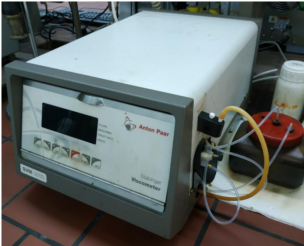
Εικόνα 10: Ψηφιακό πυκνόμετρο/ιξωδόμετρο SVM 3000 Stabinger Viscometer.
