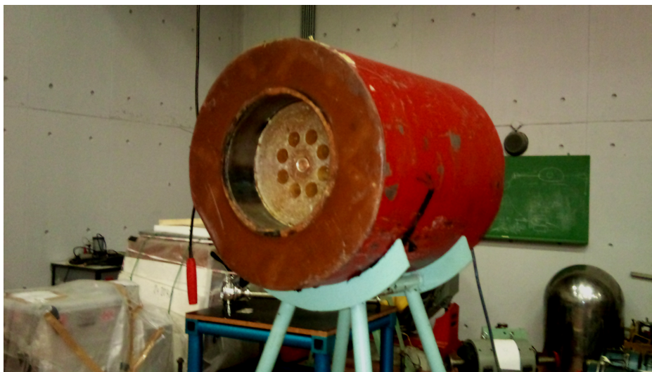
Σχήμα 8: Απαριθμητής \text{BF}_3 που χρησιμοποιείται για την παρακολούθηση των διακυμάνσεων της δέσμης των νετρονίων, κατά τη διάρκεια των ακτινοβολήσεων.
