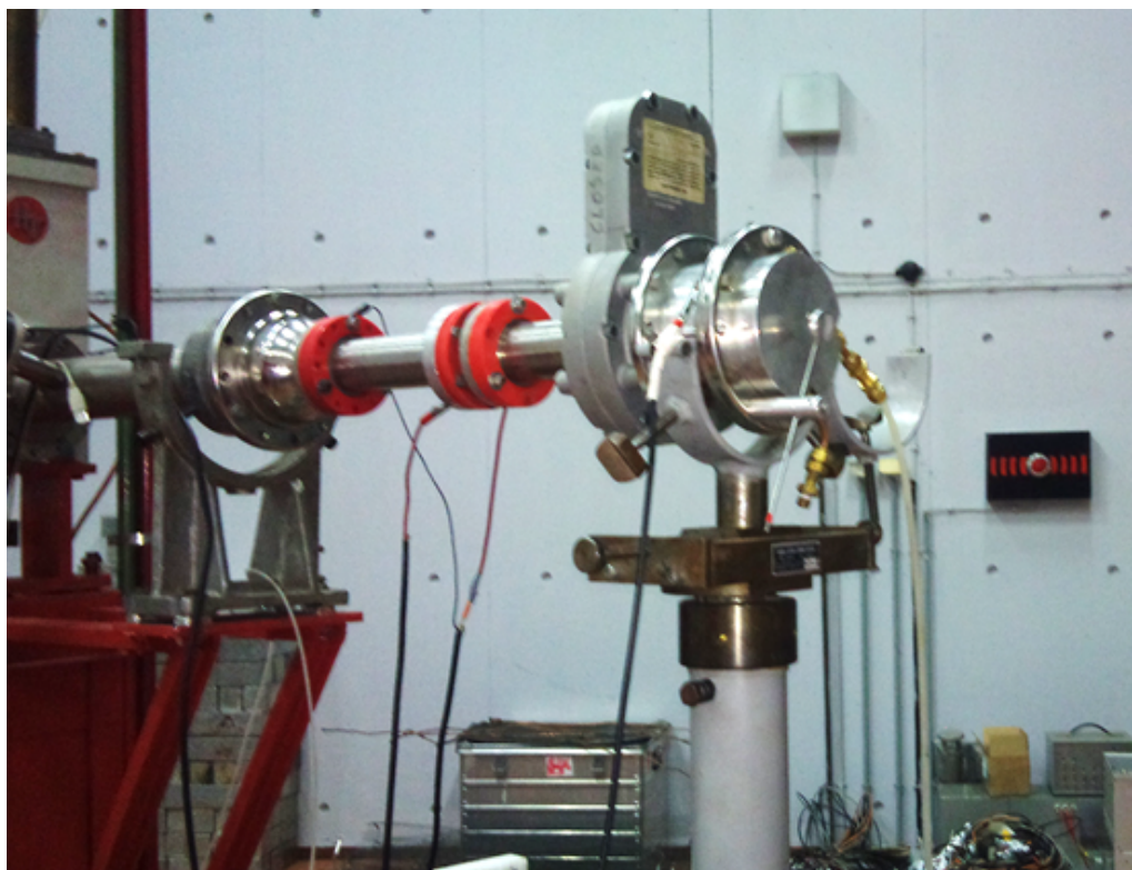
Σχήμα 7: Η άκρη της γραμμής ακτινοβολήσης στον πειραματικό χώρο του Εργαστηρίου του Επιταχυντή Tandem 5.5 MV στον "Δημόκριτο".
