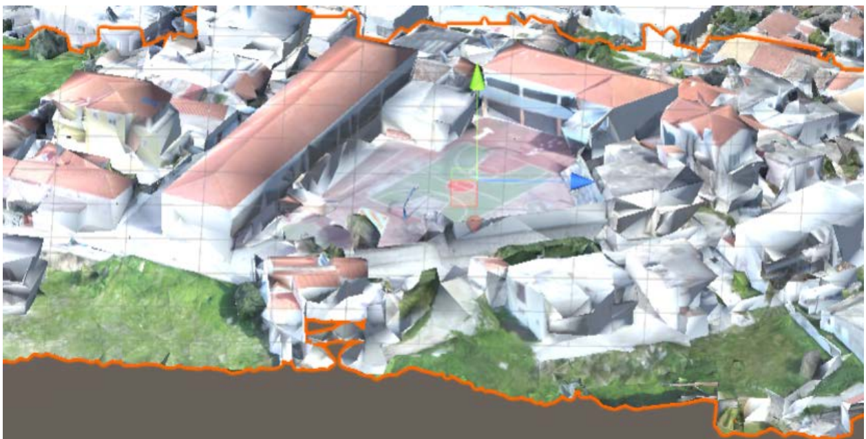
Εικόνα 3.2.11: Δεύτερο LoD με μικρό αριθμό τριγώνων
