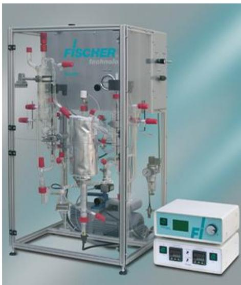
Εικόνα 10. Η συσκευή FISCHER VLE 602 μέτρησης θερμοκρασίας ισορροπίας ατμού-υγρού.
