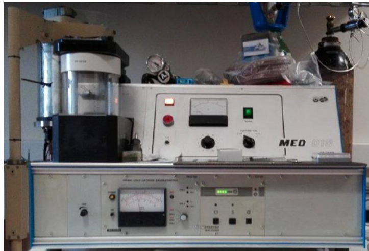
Σχήμα 5.9: Θερμικός Εξαχνωτής MED 010 Balzers
