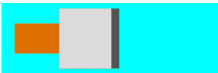
Σχήμα 5.27: Η διάταξη μετά την πρώτη απόθεση αλουμινίου
