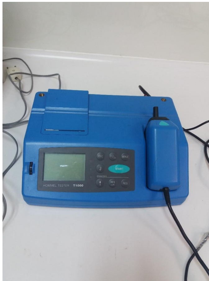
Σχήμα 3.117: Ψηφιακό προφιλόμετρο Hommel T1000
