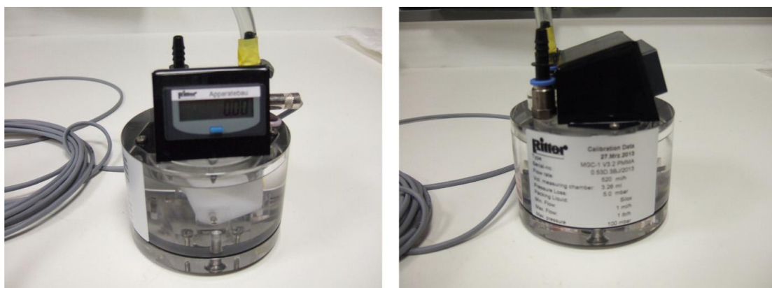
Εικόνα 10: Αυτόματος ογκομετρητής MGC-1 (PMMA cell) γεμισμένος με υγρό Silox.
