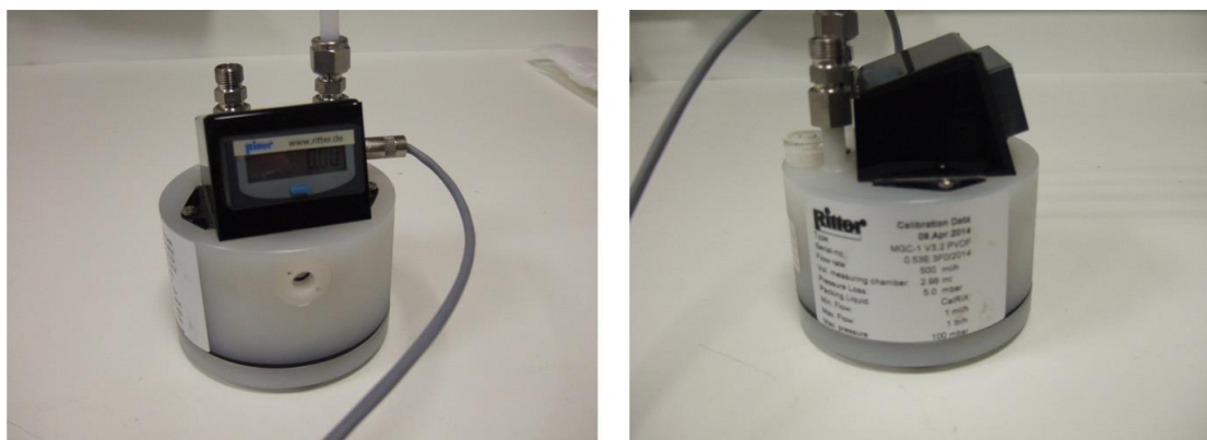
Εικόνα 11: Αυτόματος ογκομετρητής MGC-1 (PVDF cell) γεμισμένος με υγρό Calrix.
