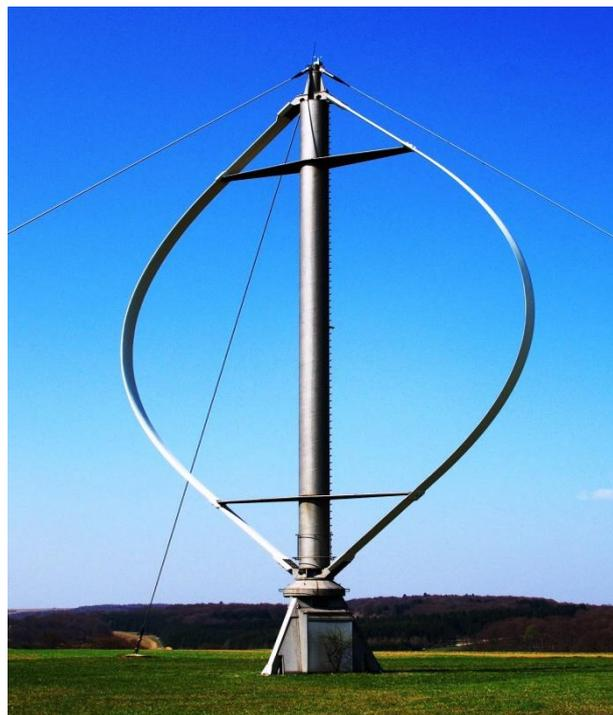
Εικόνα 2 Ανεμογεννήτρια τύπου Darrieus<sup>2</sup>
