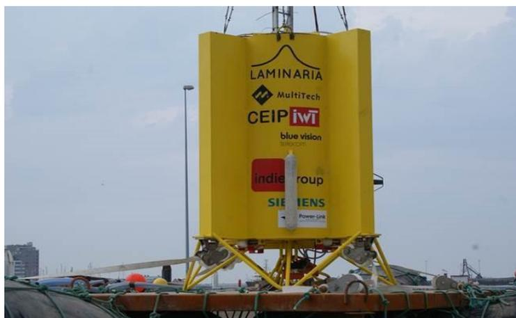
Εικόνα27 LAMINARIA: “The 200kW Laminaria WEC”<sup>28</sup>
