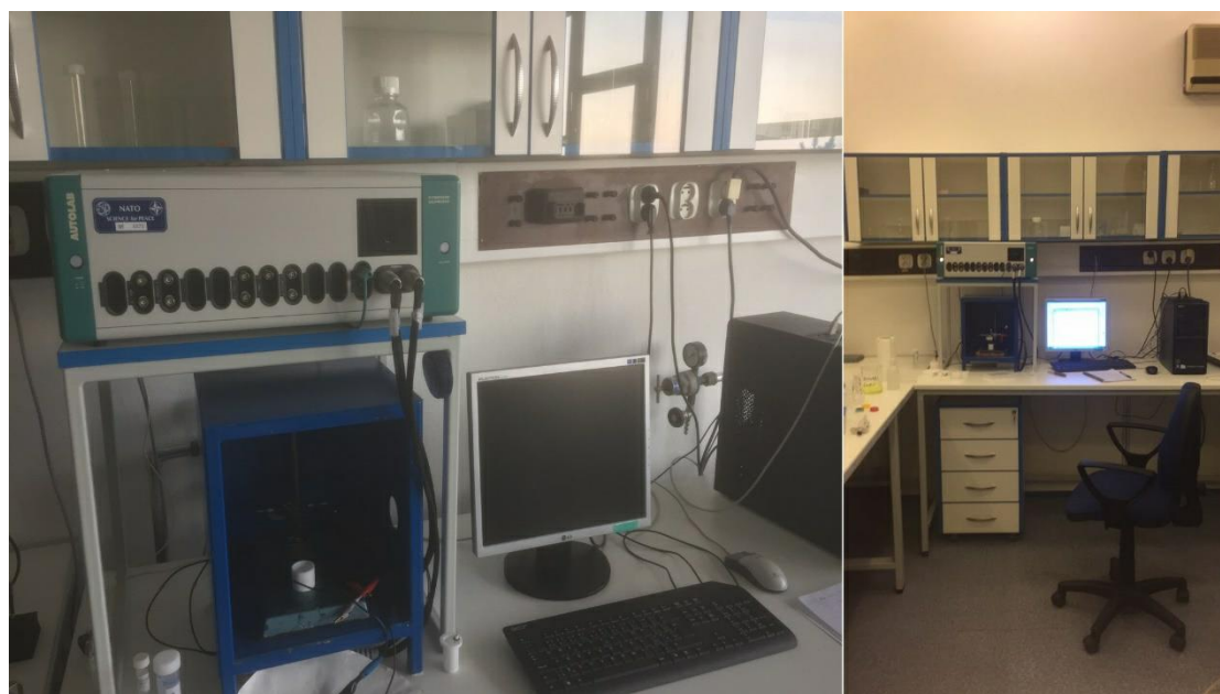
Εικόνα 6.1: Το μηχάνημα AUTOLAB PGSTAT12 που χρησιμοποιήθηκε για τα πειράματα πριν τη χρήση (αριστερά) και κατά τη διάρκεια της χρήσης (δεξιά)
