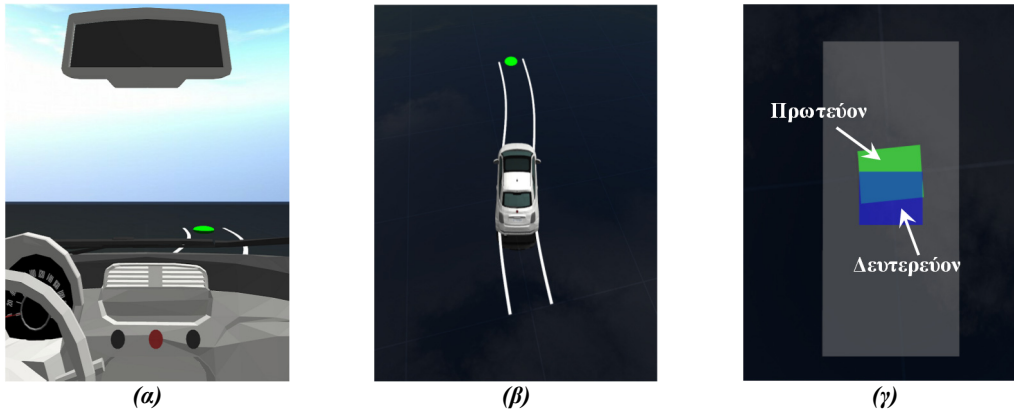
Εικόνα 1-17: Υποβοήθηση του οδηγού για την κατάλληλη τοποθέτηση του δευτερεύοντος πηνίου πάνω από το πρωτεύον [41].
