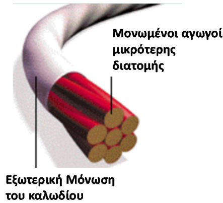
Εικόνα 2-5: Κατασκευή καλωδίου Litz 1
