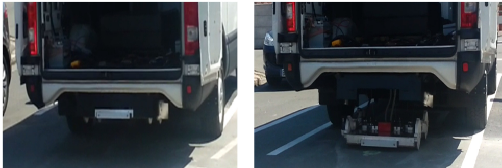
Εικόνα 1-15: Μηχανισμός Τοποθέτησης του δευτερεύοντος πηνίου.
