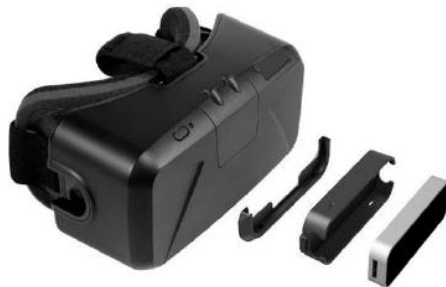
Εικόνα 40: Η ενσωμάτωση του αισθητήρα Leap Motion στο Oculus DK2
