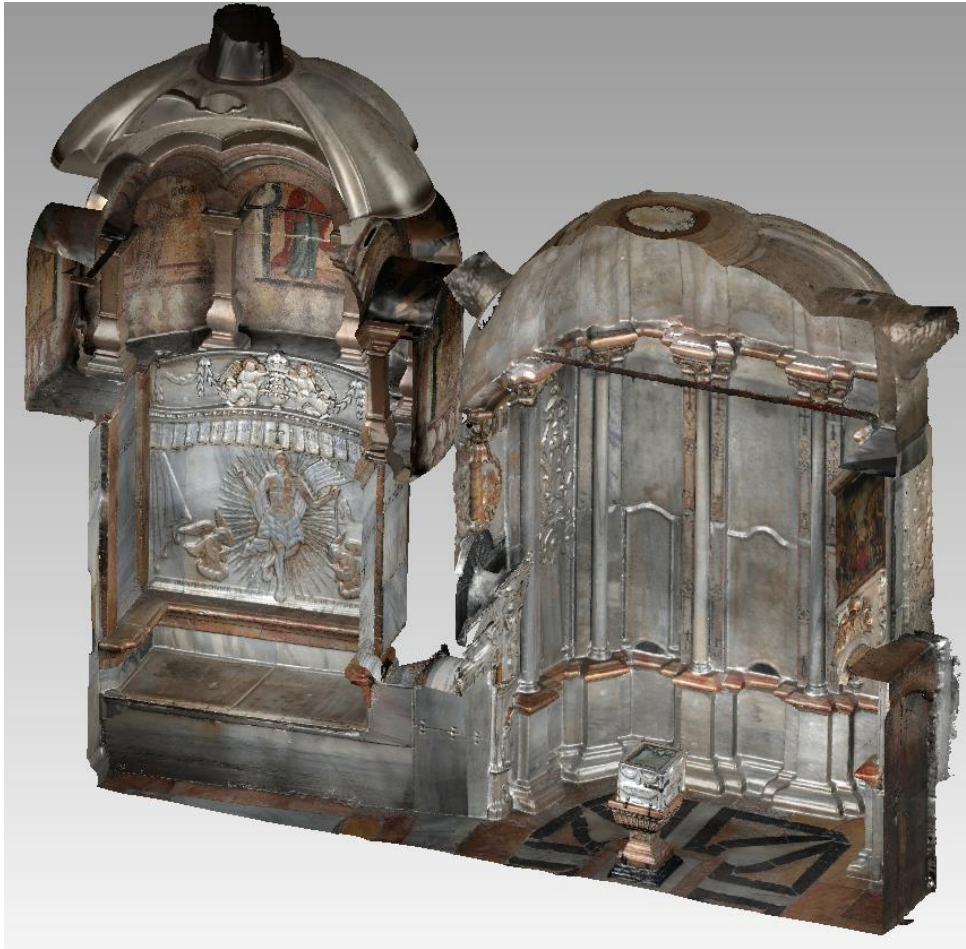
Εικόνα 83: Κατακόρυφη τομή του εσωτερικού του Ιερού Κουβουκλίου του Παναγίου Τάφου
