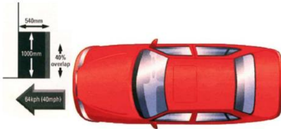
Εικόνα 3.26: Euro – NCAP οργάνωση πειράματος για δοκιμή της αντοχής του αυτοκινήτου κατά την κρούση, για μετωπική σύγκρουση
